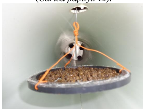
Figura 3.7- Fotografia do interior do túnel de secagem com sementes de mamão Formosa ( Carica papaya L.).
