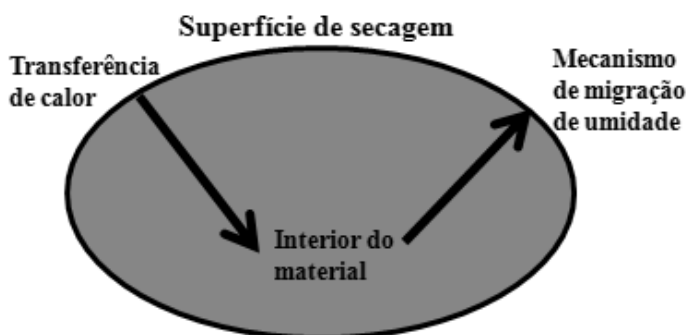
Figura 2.7- Representação da transferência de calor e de massa que ocorre na secagem.
