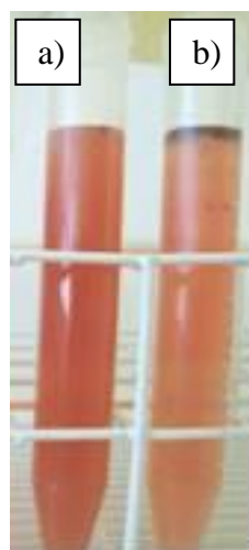
Figura 4.4- Foto de amostras de efluentes à base do corante Vermelho do Congo tratadas com as biomassas (a) inteira e fresca e (b) moída e seca, antes da etapa de centrifugação.
