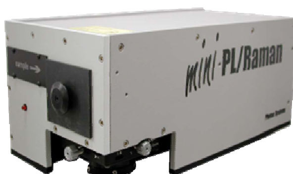
Figura 3.3: Mini PL/Raman, espectrômetro utilizado para realizar os experimentos de fotoluminescência.
