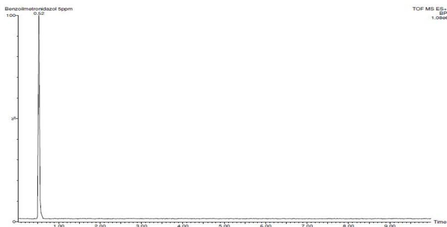
Figura 5. Cromatograma do BMZ obtido por LC-MS/MS para a caracterização da matéria-prima. Condições cromatográficas: Coluna: Acquity UPLC BEH C18 (2,1 mm × 50 mm, 1,7  $\mu$ m), mantida em 30 °C; Fase móvel: metanol: água (80:20; v/v), adicionados de ácido fórmico (0,1%); Fluxo: 0,3 mL min<sup>-1</sup>; Volume de injeção: 1,0  $\mu$ L.
