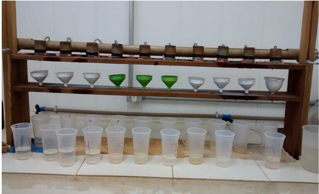
Figura 9- Ensaio de Condutividade Hidráulica. Fonte: Cardoso (2017).
