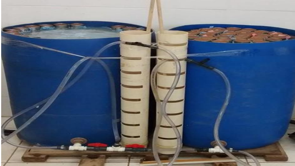
Figura 8- Coluna de areia para avaliação da macroporosidade, Método de Reinert&Reichert (2006). Fonte: Cardoso, (2017).
