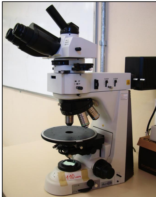
Figura 5 – Microscópio petrográfico de luz transmitida e refletida utilizado na etapa de petrografia. Laboratório de petrografia e mineralogia da Unipampa.
