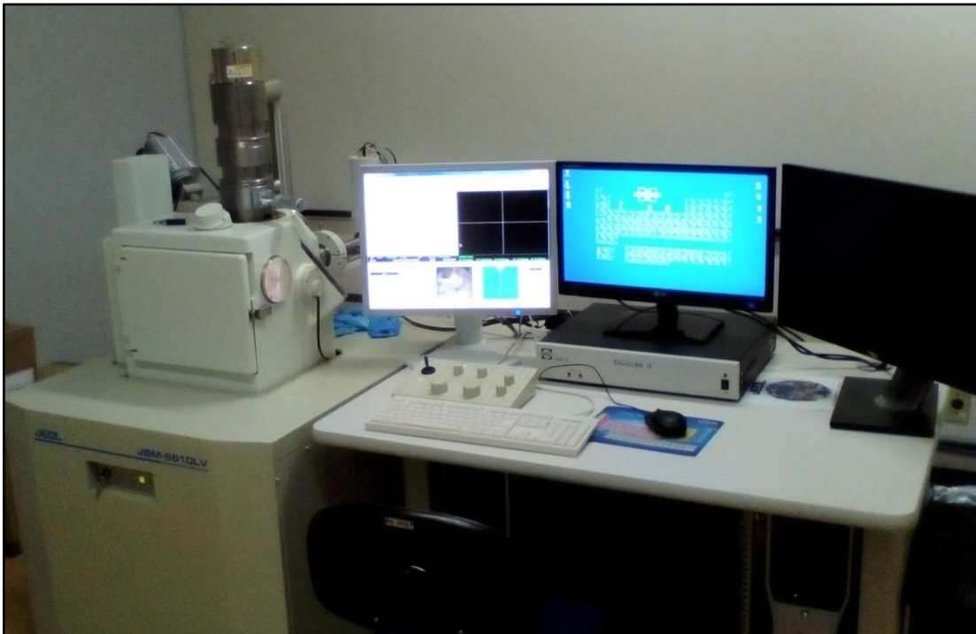
Figura 6 – Microscópio eletrônico de varredura (MEV) acoplado de um sistema de detecção de raios X por dispersão de energia (EDS). Laboratório de geologia isotópica, UFRGS.
