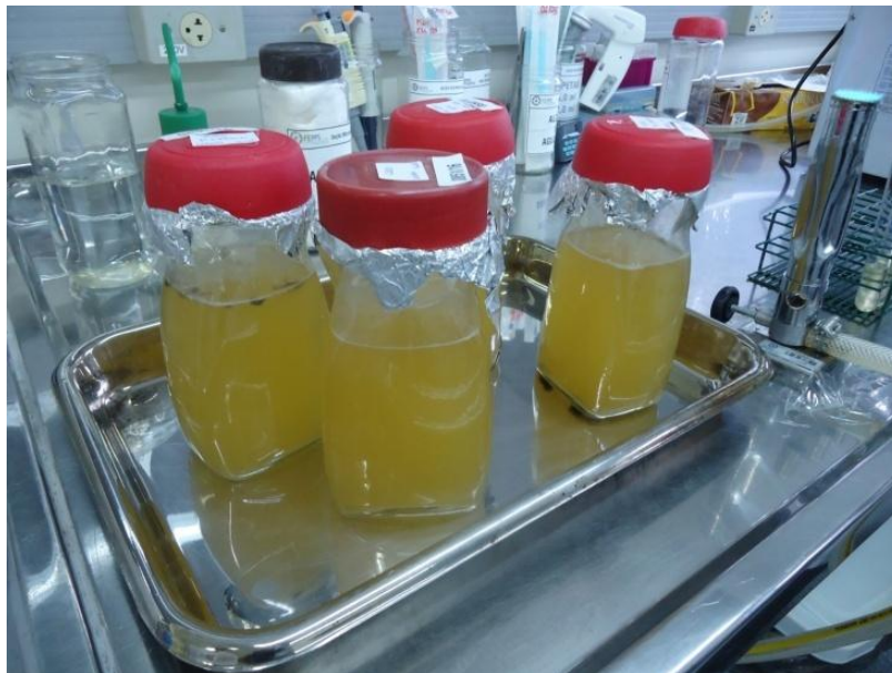
FIGURA 25 - Amostras de águas residuais após a incubação de vinte e quatro horas a 35°C. Fonte: (Arquivo Pessoal).
