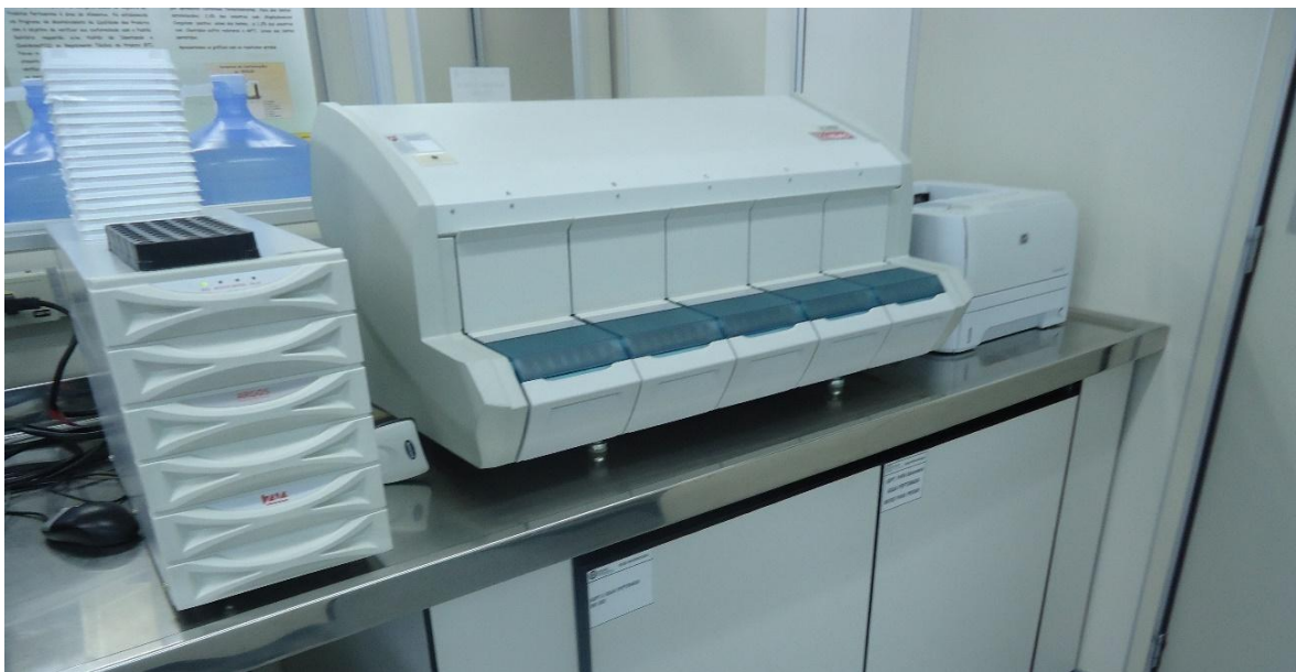
FIGURA 19 - Equipamento VIDAS® utilizado na detecção de Salmonella spp. Fonte: (Arquivo Pessoal).
