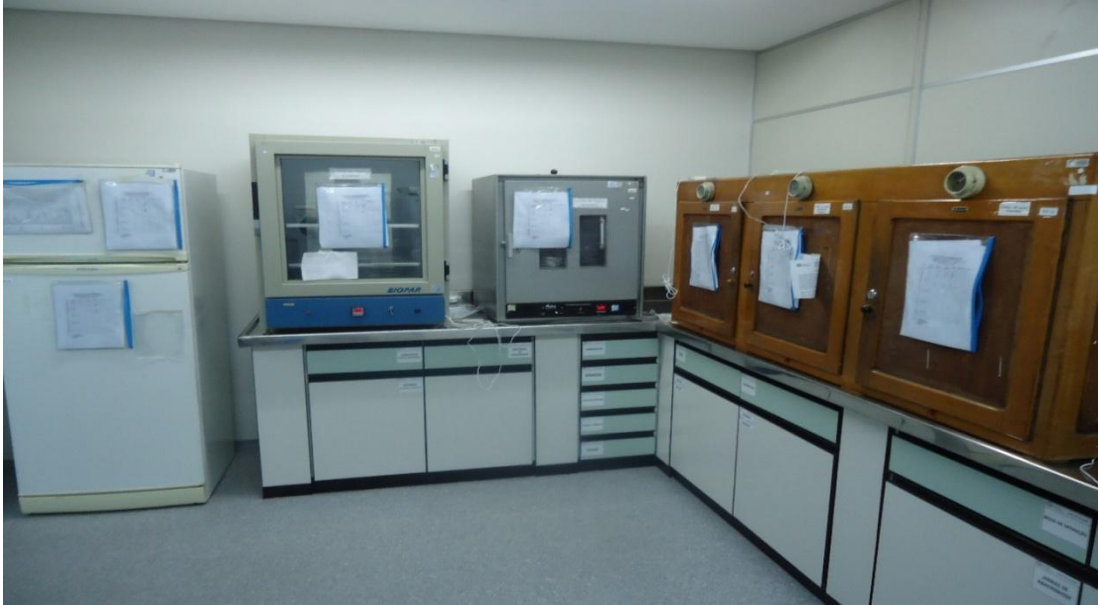
FIGURA 14- Sala de equipamentos - estufas, freezer e refrigeradores para manutenção de micro-organismos (cada um apresentando planilhas de acompanhamento de temperatura afixadas no lado de fora). Fonte: (Arquivo Pessoal).
