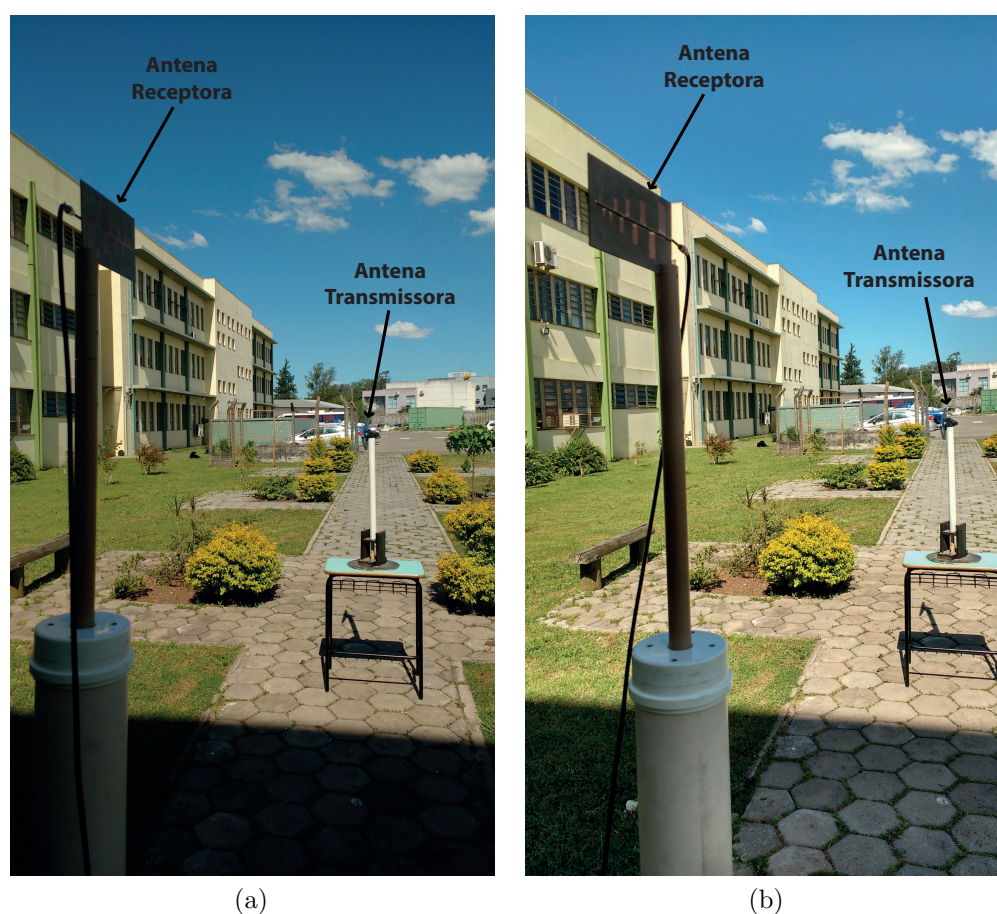
Figura 60 – Medição do plano H (a) antenas em visada direta, (b) rotação da antena receptora de 180° a 360°
