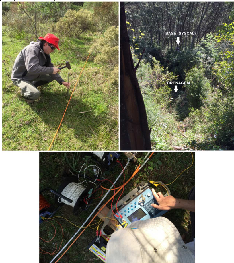
Figura 13 - Preparação dos arranjos de Eletrorresistividade.
