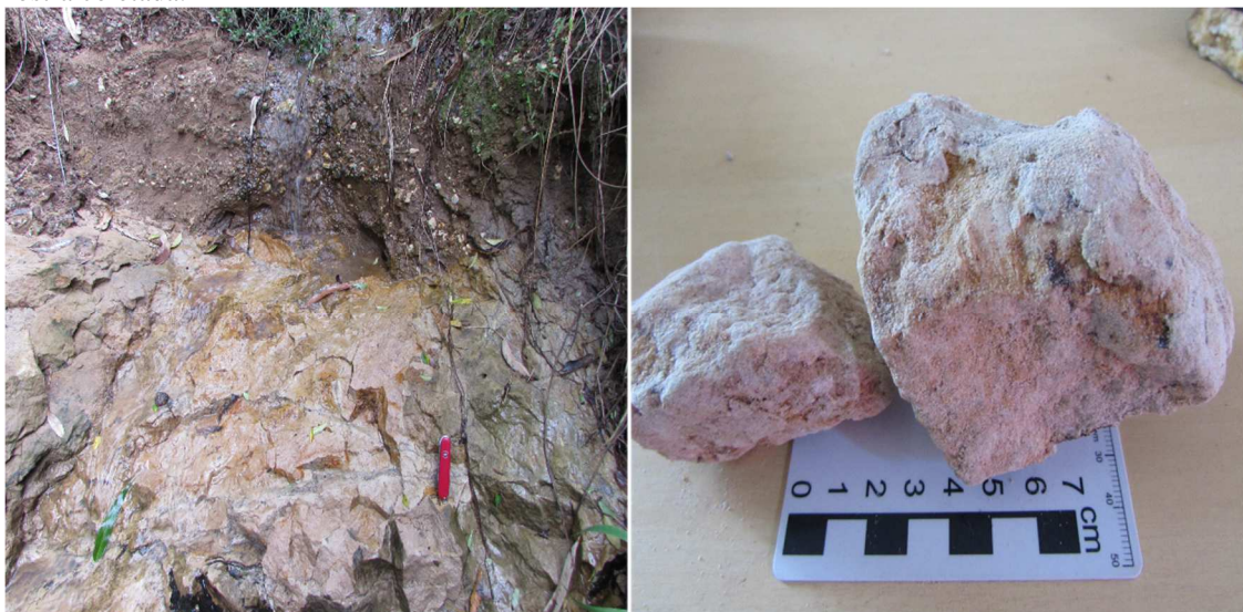
Figura 25 - Afloramento de arenito em leito de córrego, nota-se a camada de solo logo a cima. Junto a amostra coletada.
