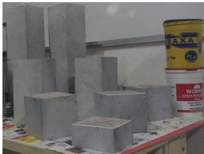
Figura 24 – Corpos de provas livres nas faces do carregamento
