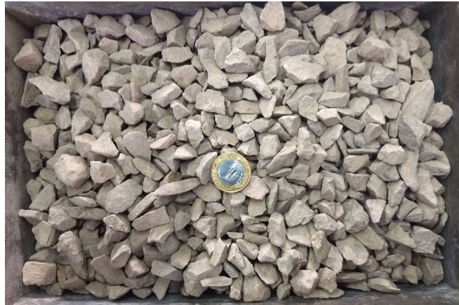
Figura 16 – Brita 1 utilizada no presente estudo
