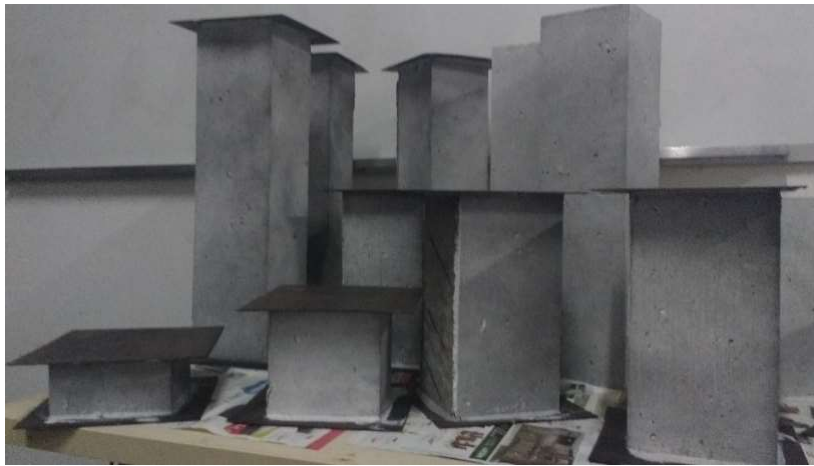
Figura 23 – Corpos de provas presos nas faces do carregamento
