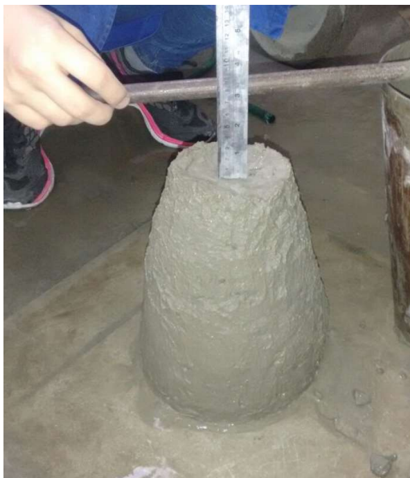
Figura 21 – Ensaio slump test
