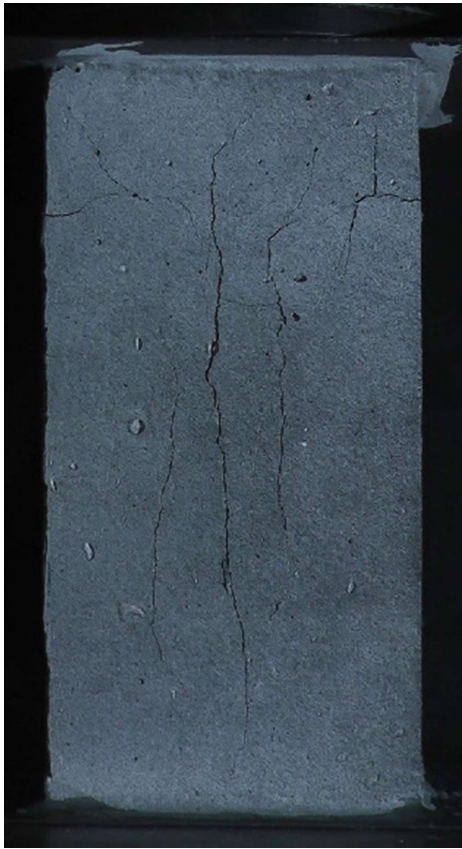
Figura 55 – Corpos de prova de 20cm de altura, amostras com atrito. A) amostra experimental, B) amostra durante a simulação numérica
