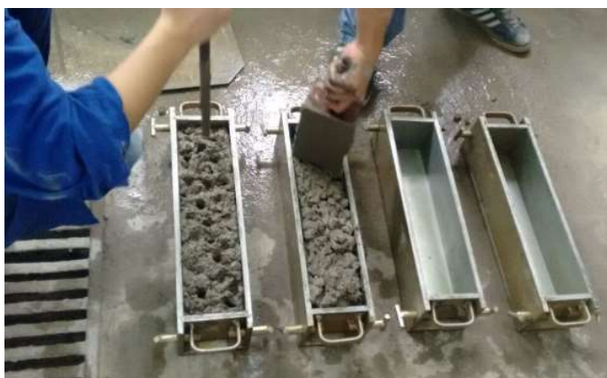
Figura 22 – Moldagem dos corpos de provas
