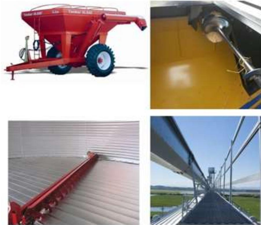
Figura 4 - Principais aplicações das roscas helicoidais no transporte de grãos. (Fonte: Montagem de própria autoria)
