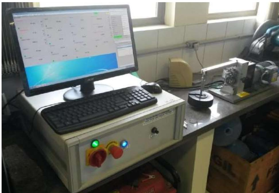
Figura 37 - Equipamento utilizado para realização do ensaio de desgaste (Fonte: Própria autoria)
