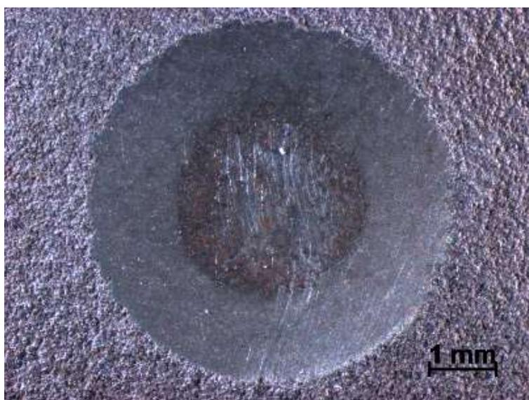
Figura 44 - Calota gerada no ensaio de abrasão. (Fonte: Própria autoria)
