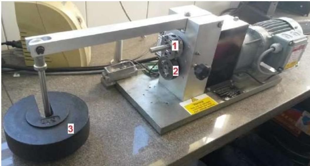
Figura 38 - Detalhes do equipamento de ensaio de desgaste. (Fonte: Própria autoria)
