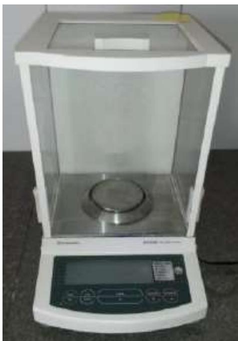
Figura 39 - Balança Shimadzu utilizada para medição da massa. (Fonte: Própria autoria)
