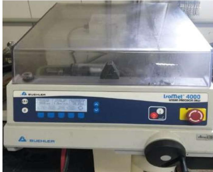
Figura 30 - Cortadora de precisão (Fonte: Própria autoria)
