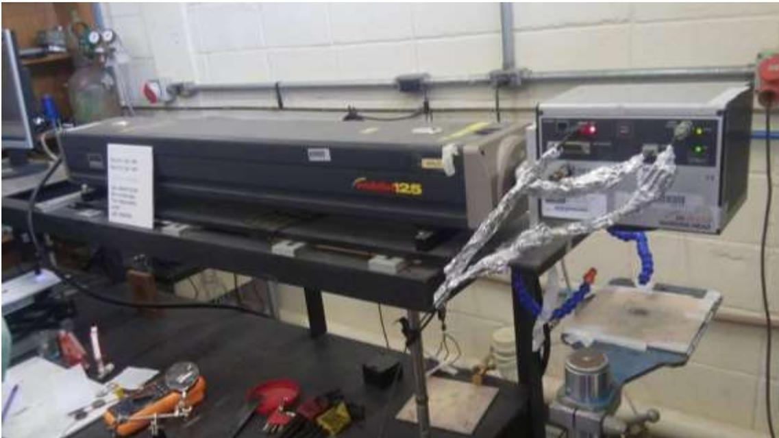
Figura 25 - Laser de CO<sub>2</sub> utilizado para o revestimento. (Fonte: Própria autoria)
