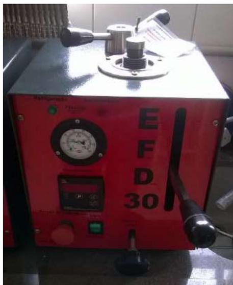
Figura 31 - Embutidora digital (Fonte: Própria autoria)
