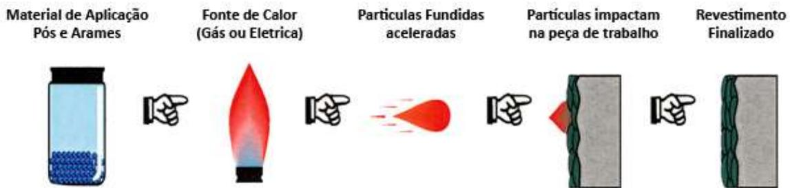
Figura 6 - Esquema de funcionamento do processo de aspersão térmica. (Fonte: Comersul – Aspersão Térmica e Soldas Especiais)
