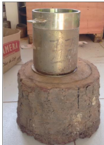
Figura 31 – Execução do ensaio de compactação
