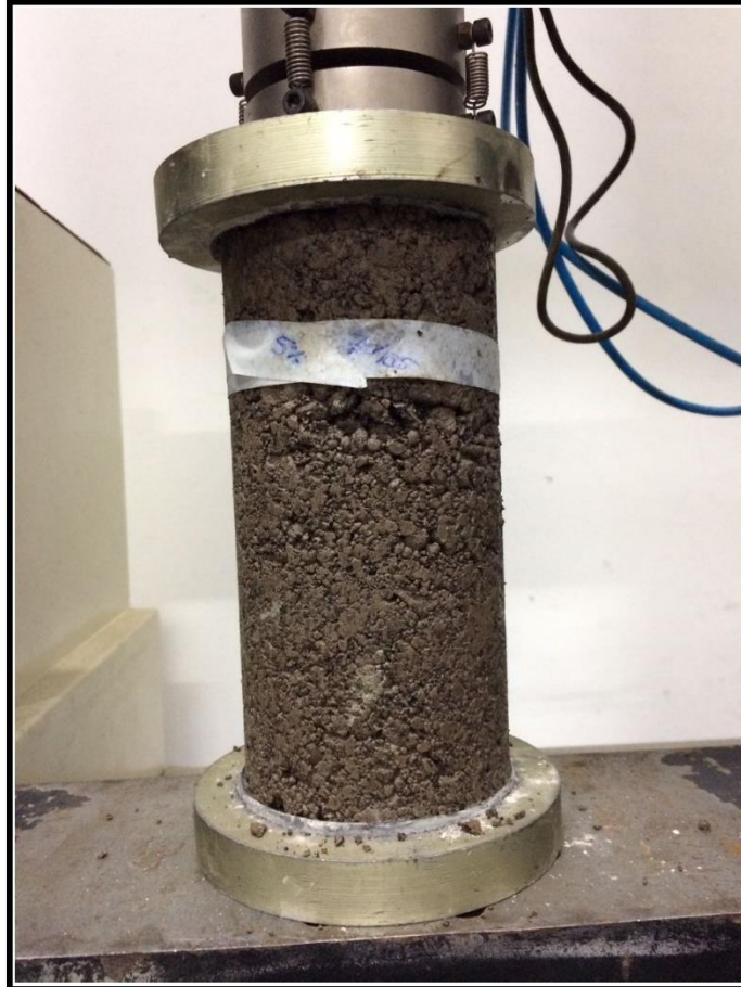
Figura 32 – Execução do ensaio de resistência a compressão simples
