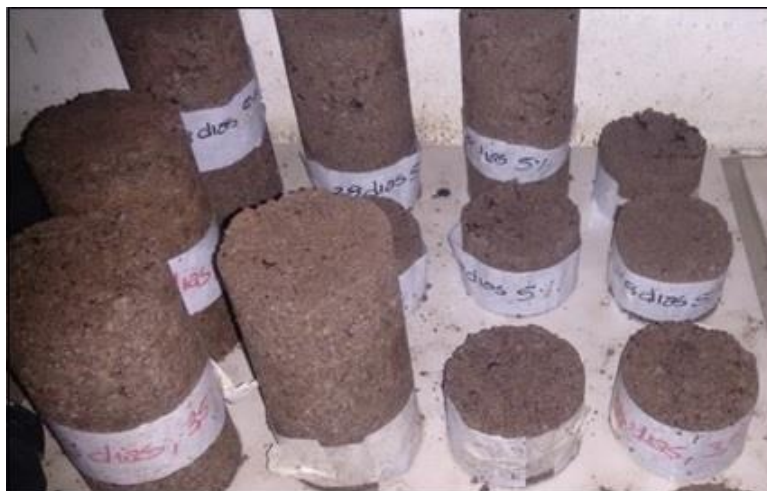
Figura 21 – Estados físicos das misturas de cimento
