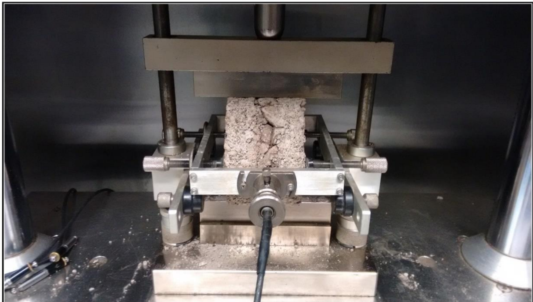
Figura 35 – Execução ensaio de módulo de resiliência
