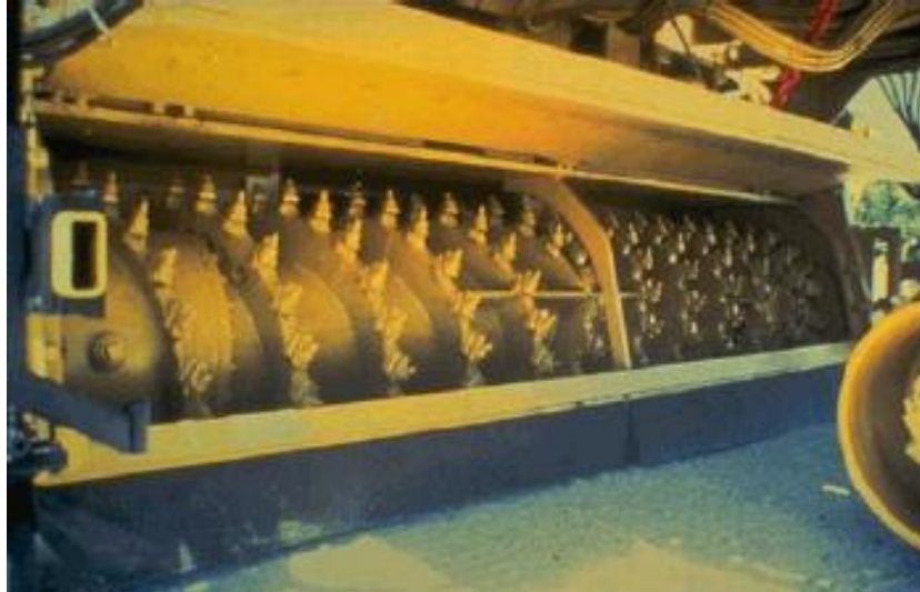
Figura 7 – Tambor com fresas da máquina fresadora
