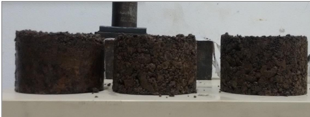
Figura 23 – Corpos de prova para RTCD/MR com diferentes teores de cimento
