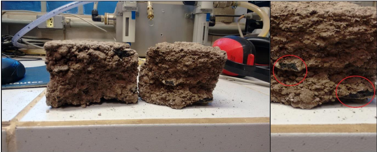
Figura 40 – Amostra rompida por compressão diametral
