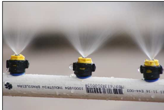
Figura 23 – Efeito vórtice do micro aspersor.
