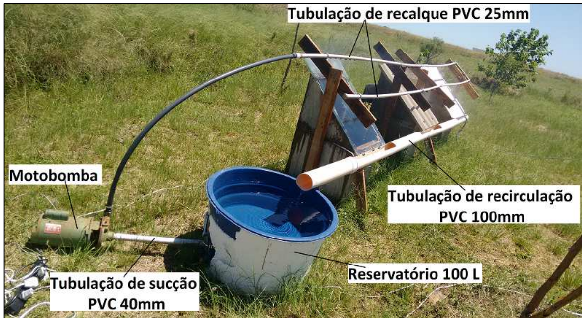
Figura 21 – Sistema de percolação nas células-teste.
