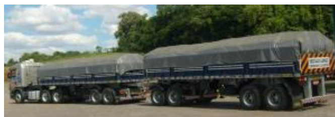
Figura 5 - Rodotrem é um cavalo tracionando um semirreboque mais um reboque.
