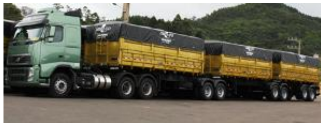
Figura 4 - Tritrem: Cavalo mecânico que traciona três semirreboques.
