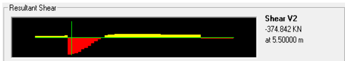
Figura 42 - Diagrama do máximo esforço cortante, gerado pelo trem-tipo, na viga principal.
