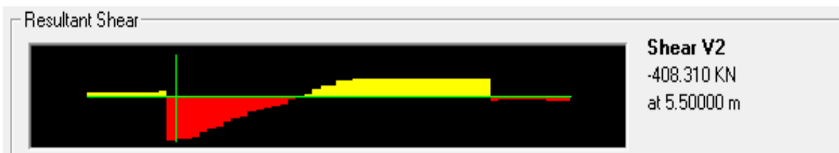
Figura 43 - Diagrama do máximo esforço cortante, gerado pelo veículo real, na viga principal.
