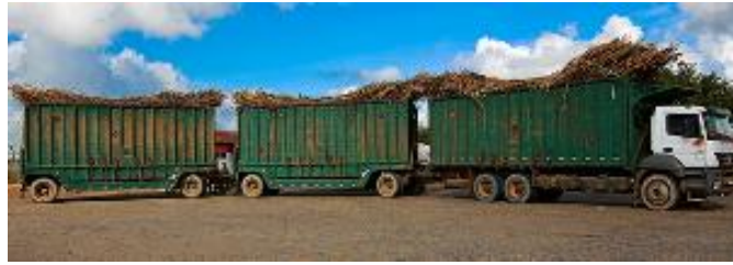
Figura 6 - Treminhão é um caminhão tracionando dois ou mais reboques
