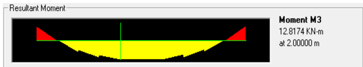
Figura 44 - Diagrama do máximo momento fletor positivo, gerado pelo trem-tipo, na laje.
