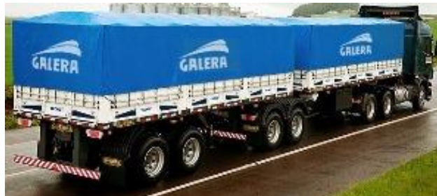
Figura 3 - Bitrem: Cavalo mecânico que traciona dois semirreboques.
