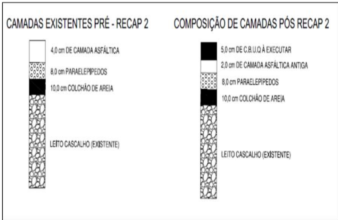
Figura 28 – Composição de camadas antes e depois da operação de RECAP 2 na Rua dos Andradas
