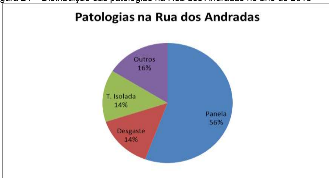
Figura 24 – Distribuição das patologias na Rua dos Andradas no ano de 2013
