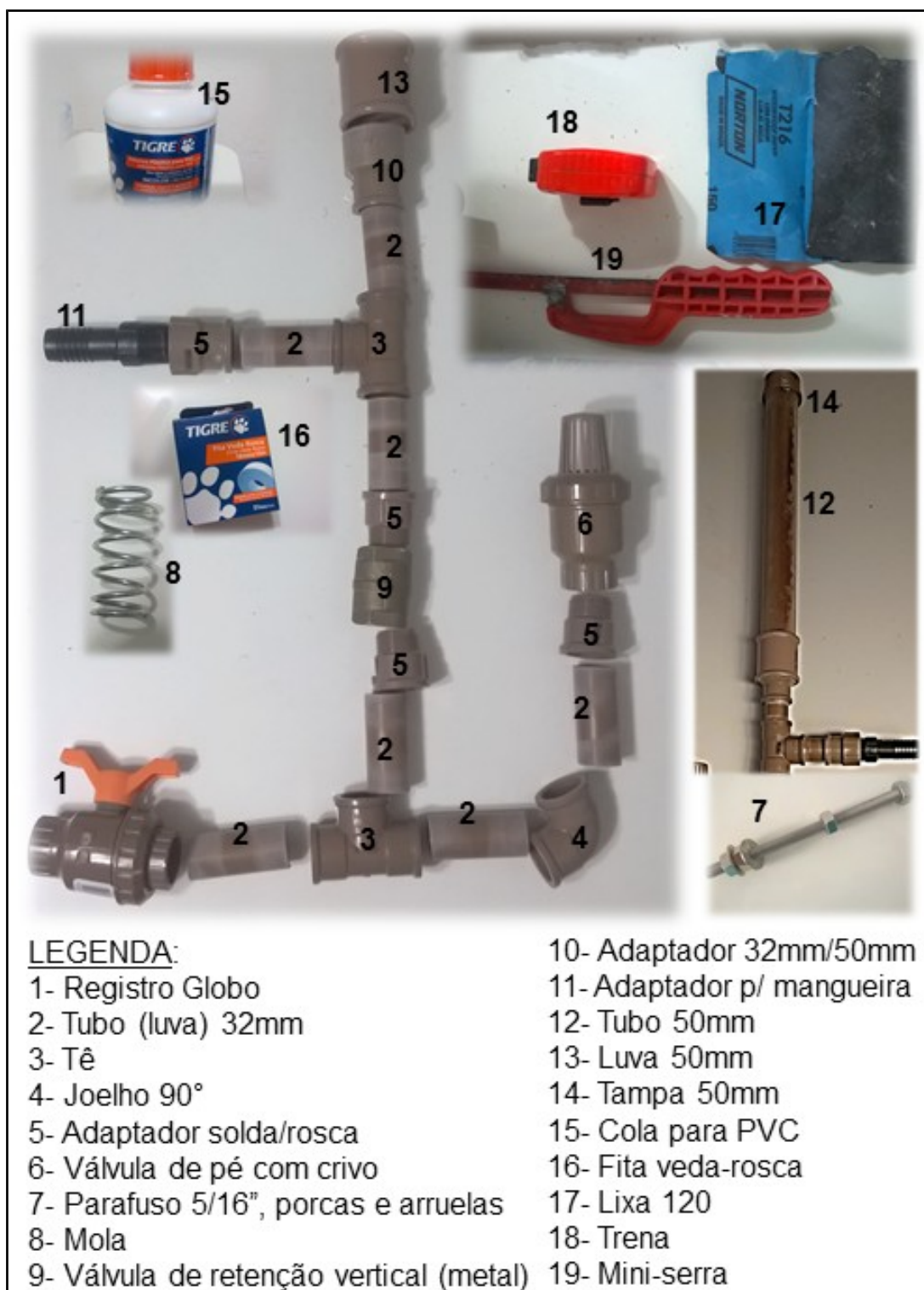
Figura 18 – Principais materiais utilizados na construção da bomba
