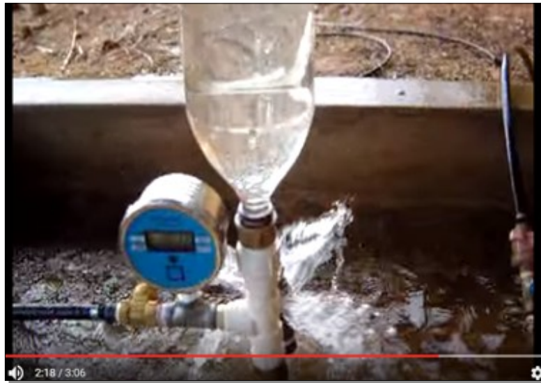
Figura 15 – Bomba de aríete com garrafa PET
