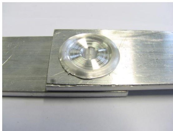
Figura 25 - Junta sobreposta obtida pelo processo FSSW.
