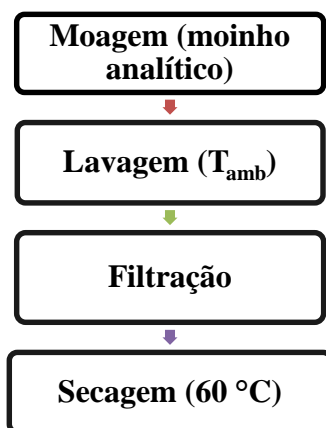
Figura 3 - Metodologia de preparo das amostras de caroço de azeitona in natura utilizada nesse estudo.
