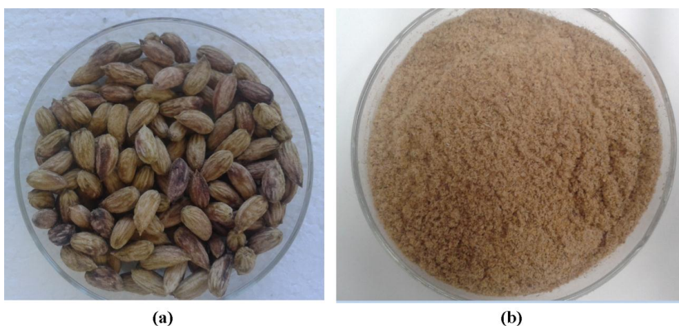
Figura 4 - Amostra resultante do processo de moagem, lavagem e secagem. Em (a) caroços brutos e em (b) caroços de azeitona moídos, lavados e secos.
