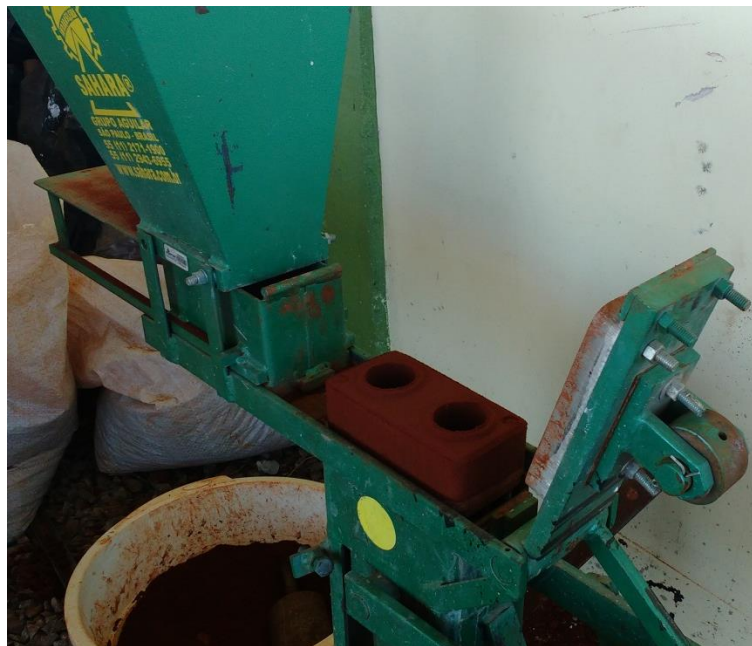
Figura 13 – Moldagem dos tijolos
