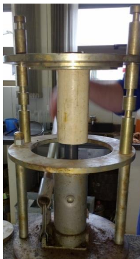
Figura 7 – Macaco hidráulico para a extração de CP
