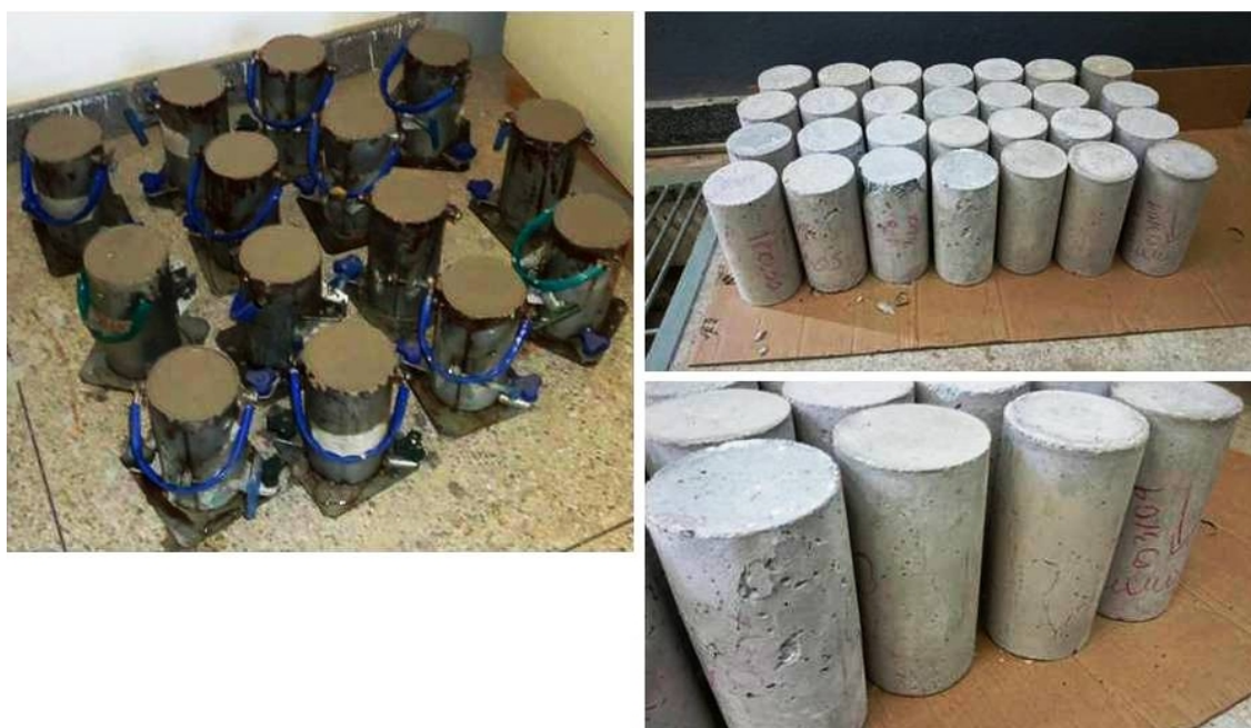
Figura 10 – Corpos de prova das empresas E1, E2 e da brita de referência moldados e rompidos, respectivamente.
