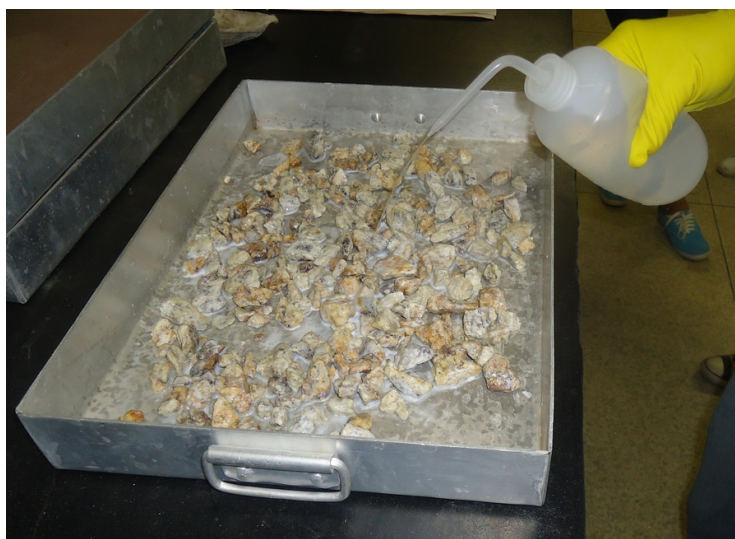
Figura 7 – Amostra da empresa E1 lavada com a solução de Cloreto de Bário ( \text{BaCl}_2 ).
