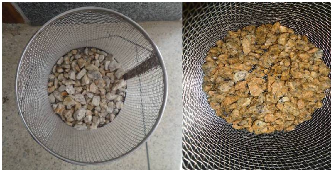
Figura 8 – Amostras das empresas E1 antes dos ciclos de imersão e da empresa E2 depois dos 5 ciclos de imersão
