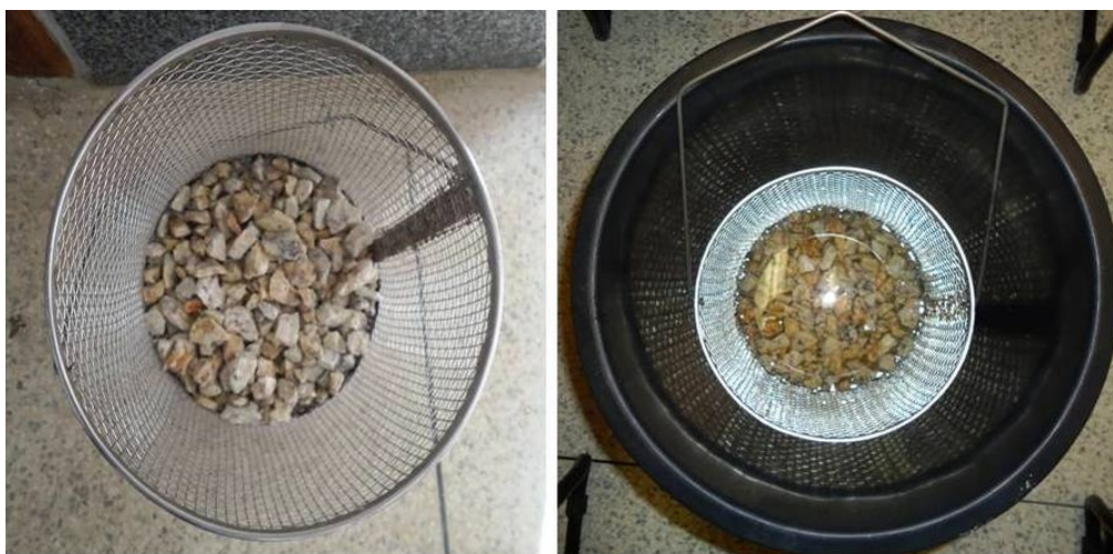
Figura 6 – Amostras das empresas E1 antes do ensaio de durabilidade e a amostra da empresa E2 durante a imersão na solução de Sulfato de Sódio Anidro ( \text{Na}_2\text{SO}_4 ).
