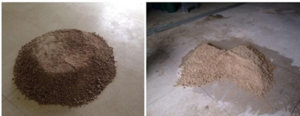
Figura 4 – Material britado, sendo homogeneizado em pilhas cônicas e quarteado.
