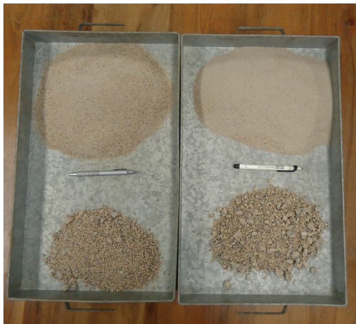
Figura 5 – Amostras dos materiais passante e retido na peneira 1,7 mm.
