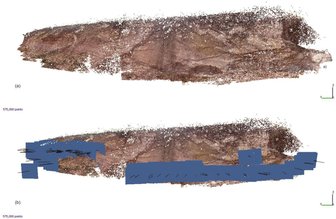
Figura 18 - Nuvem de pontos de amarração (a) e câmeras utilizadas para a geração do modelo (b).
