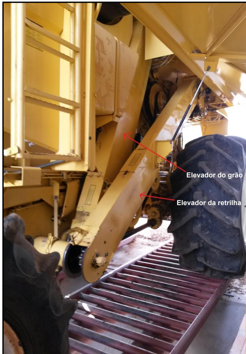
Figura 2 - Ilustração dos elevadores de grão e retilha TC 57.
