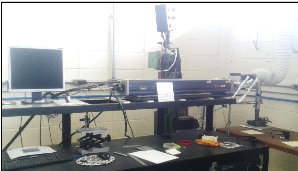
Figura 30 - Laser de CO 2 . Na caixa retangular localizam-se os espelhos galvanométricos que guiam o feixe na superfície da amostra.
