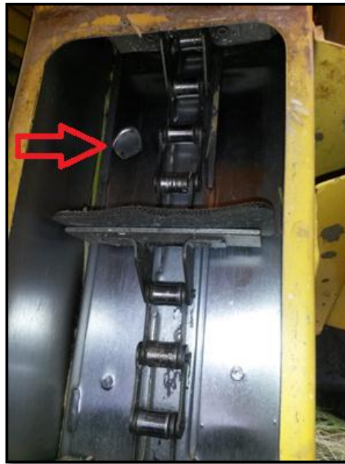
Figura 5 - Elevador do grão com desgaste.
