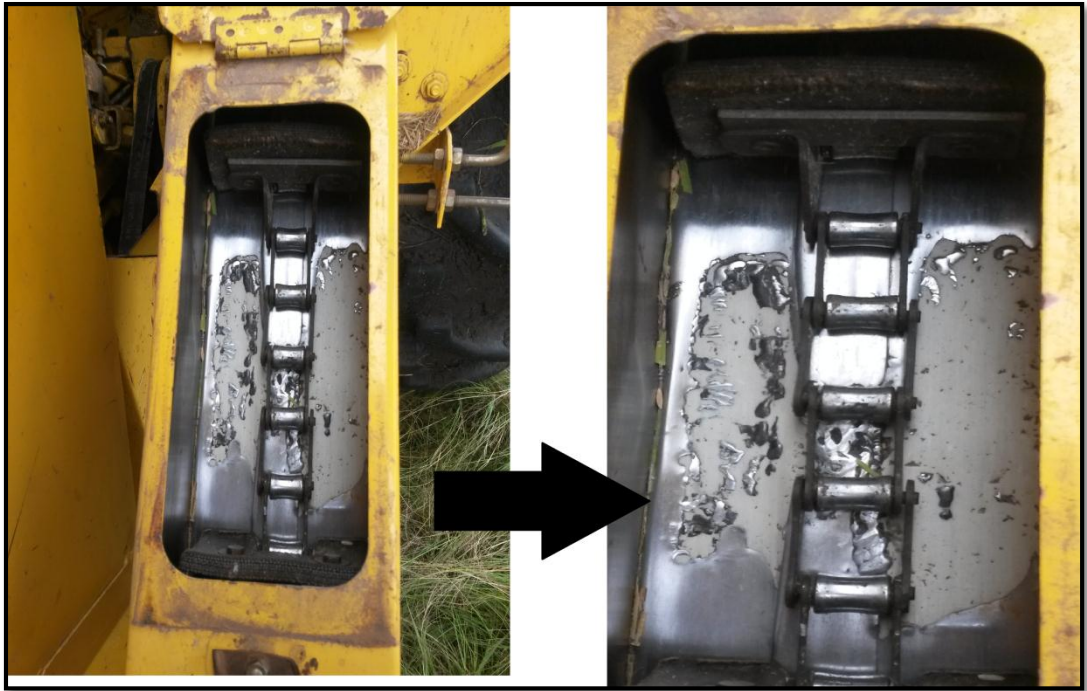
Figura 3 - Elevador de retilha com desgaste preenchido com solda.
