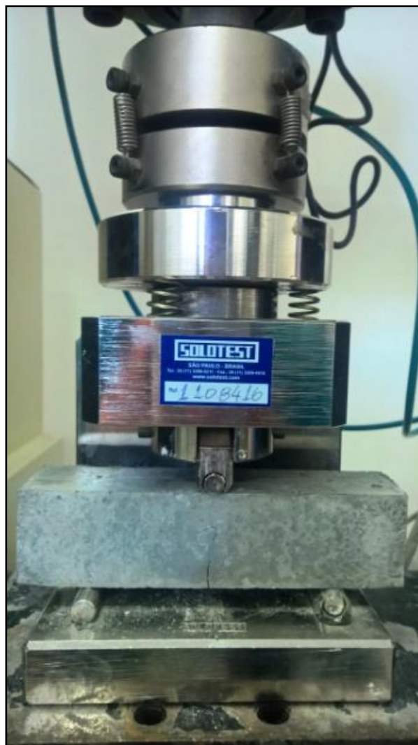
Figura 17 - Instrumentação do ensaio de tração na flexão em três pontos
