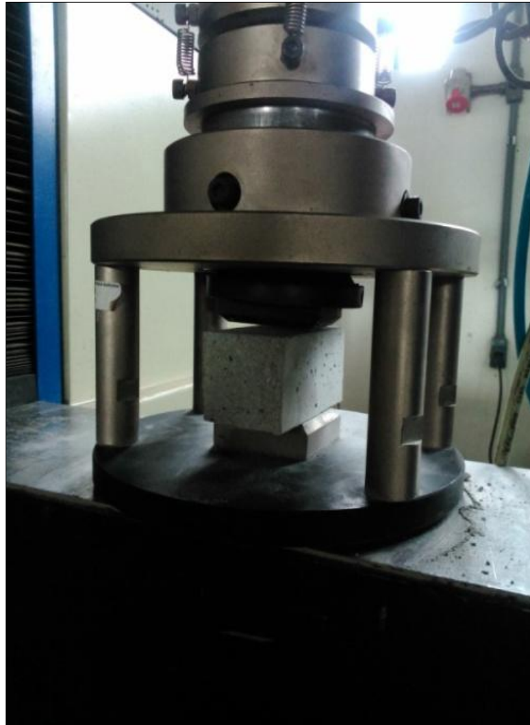
Figura 16 - Compressão simples: máquina de ensaios universais DL 20000
