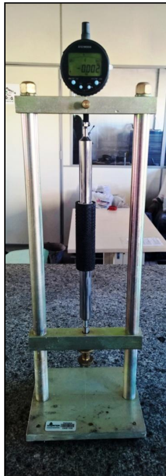
Figura 12 - Equipamento utilizado para a medição das barras de argamassa composto por medidor digital e barra de calibragem
