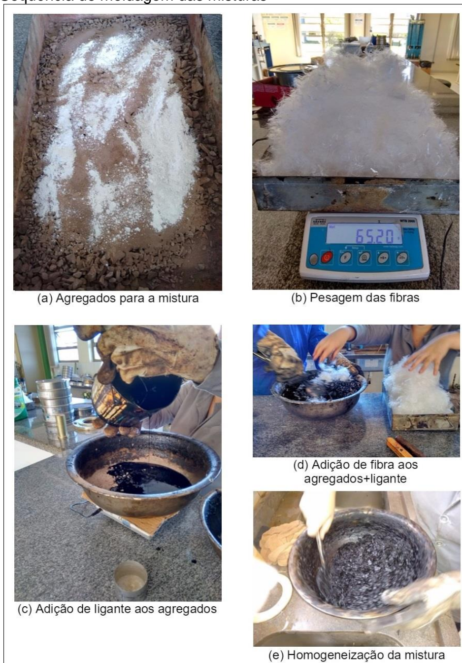
Figura 20 – Sequência de moldagem das misturas
