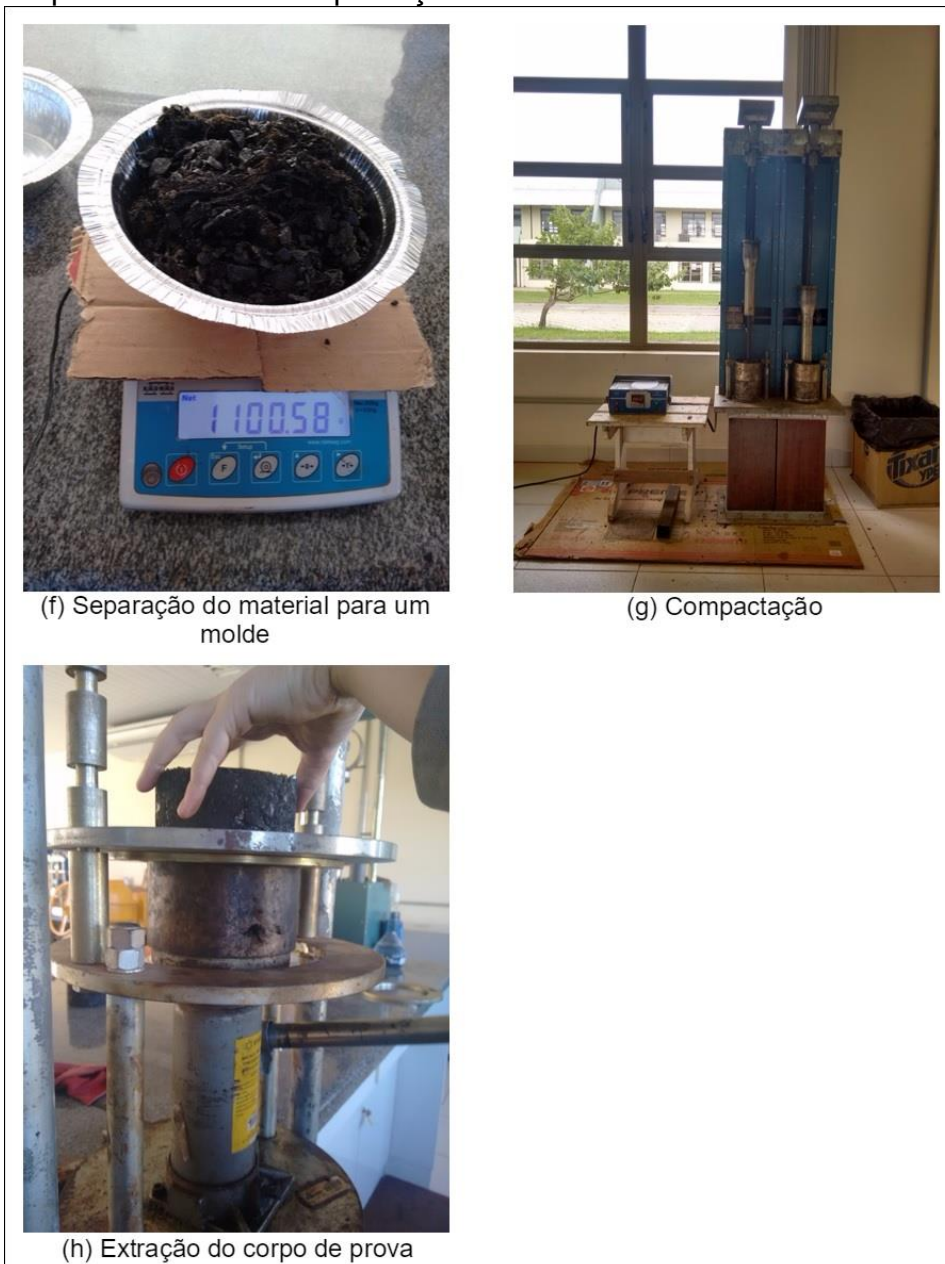
Figura 21 – Sequência final de compactação e desmolde
