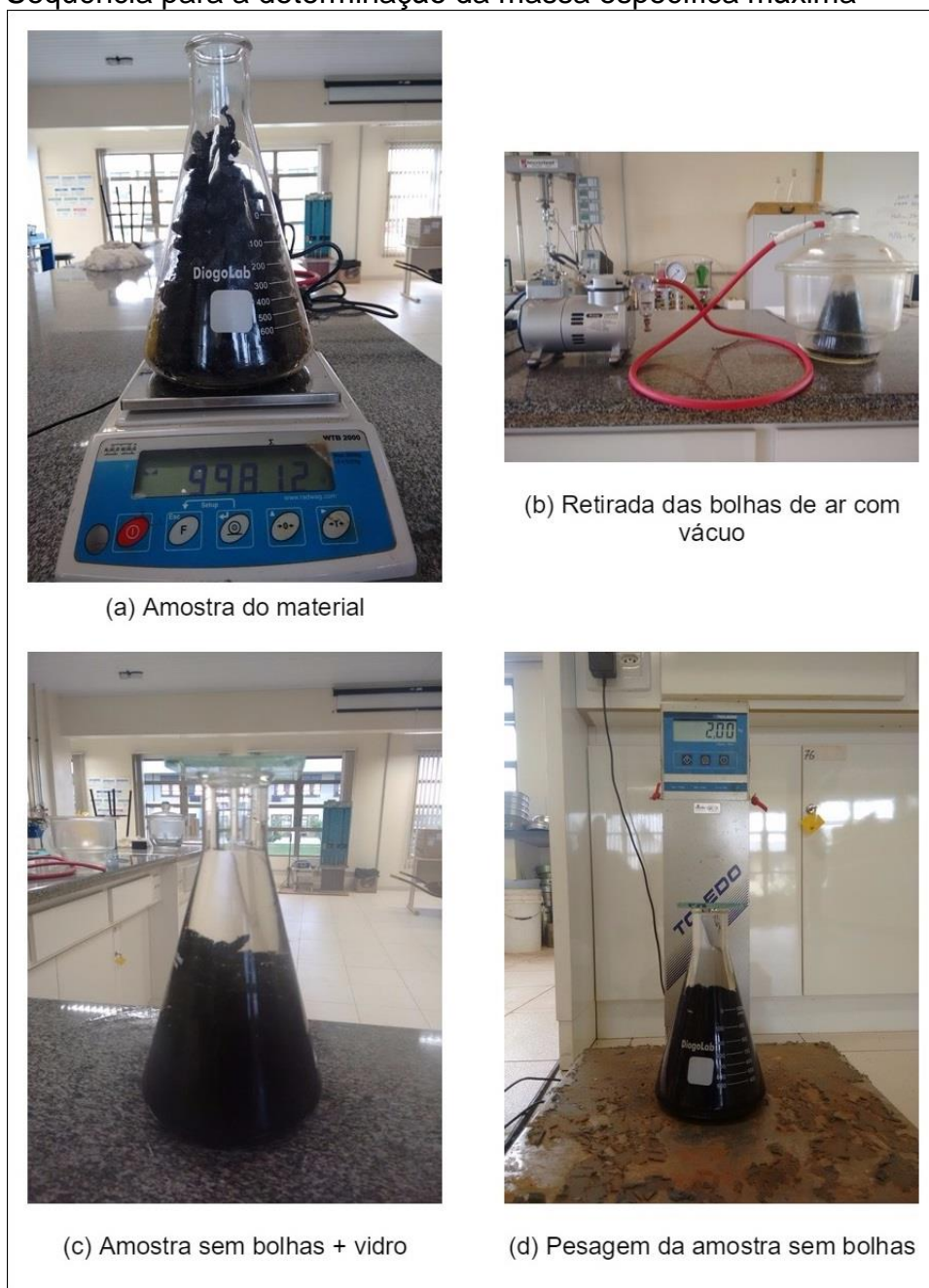
Figura 23 – Sequência para a determinação da massa específica máxima
