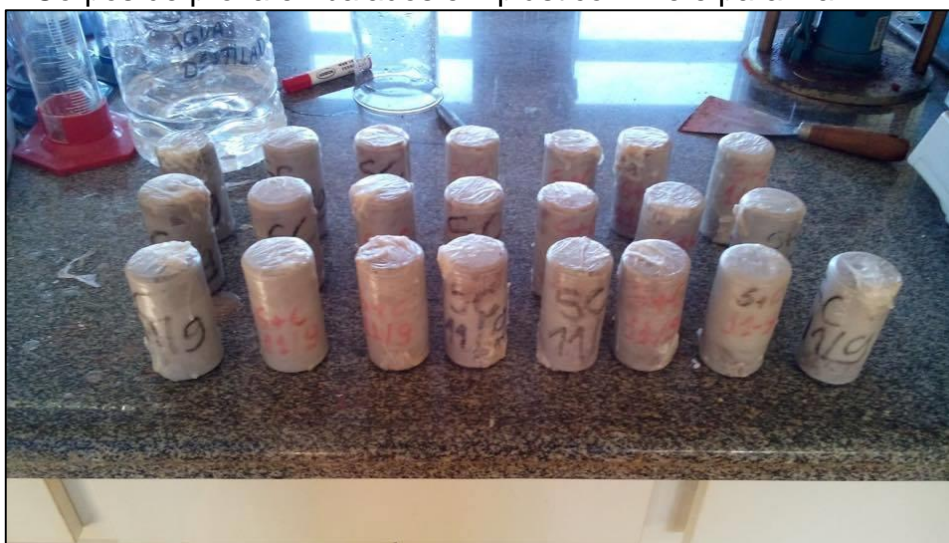
Figura 21: Corpos de prova embalados em plástico filme e parafina
