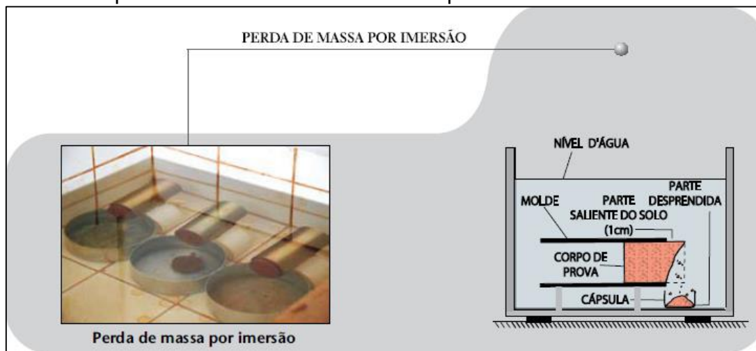
Figura 15: Croqui do Ensaio de Perda de Massa por Imersão
