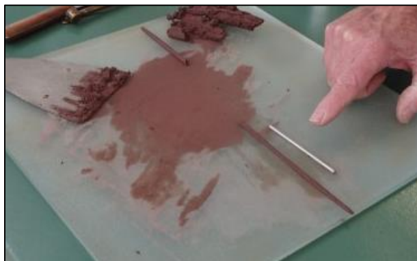
Figura 7: Execução do ensaio de Limite de Plasticidade.
