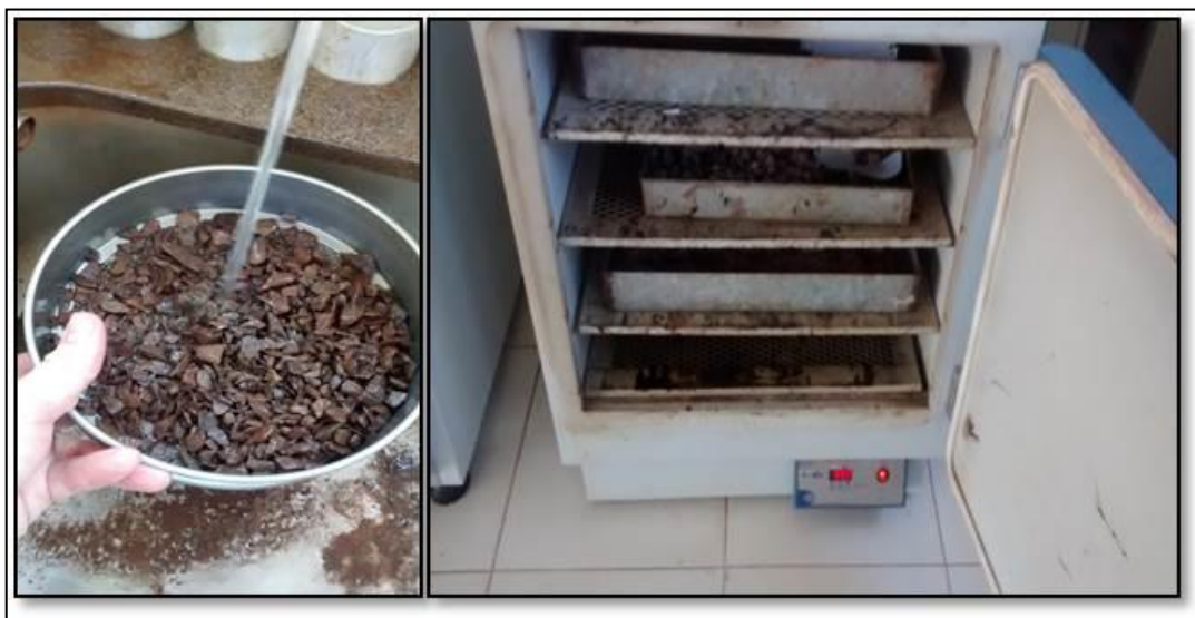
Figura 16 – Limpeza e secagem dos agregados
