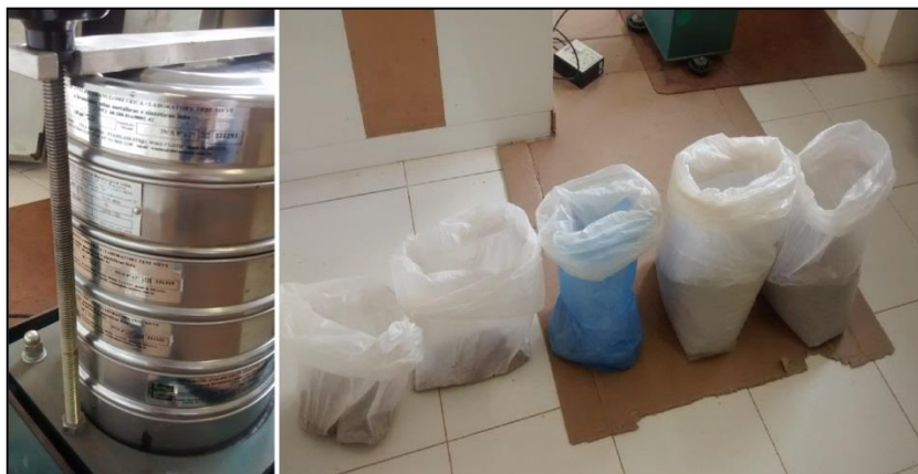
Figura 17 – Peneiramento e separação granulométrica do material
