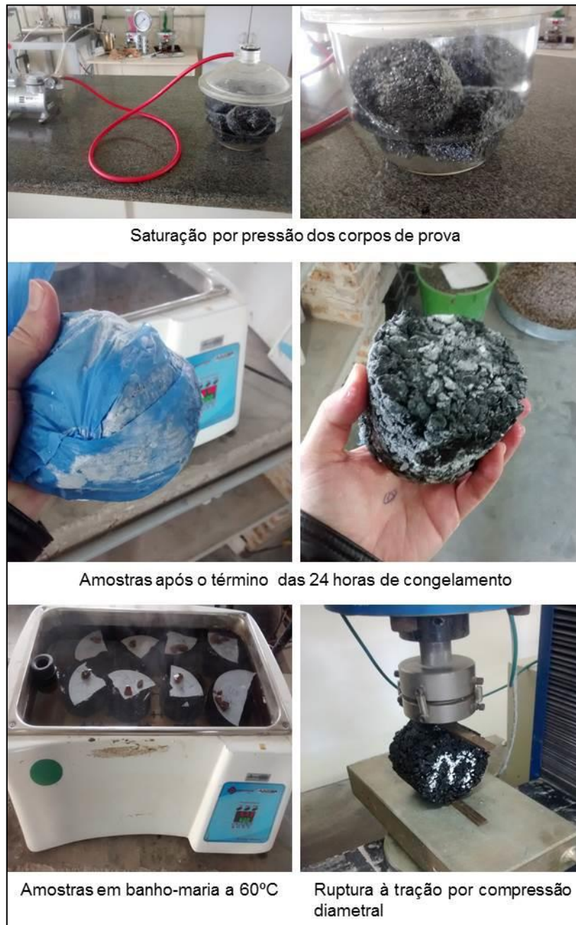
Figura 22 – Etapas do condicionamento das amostras do segundo grupo
