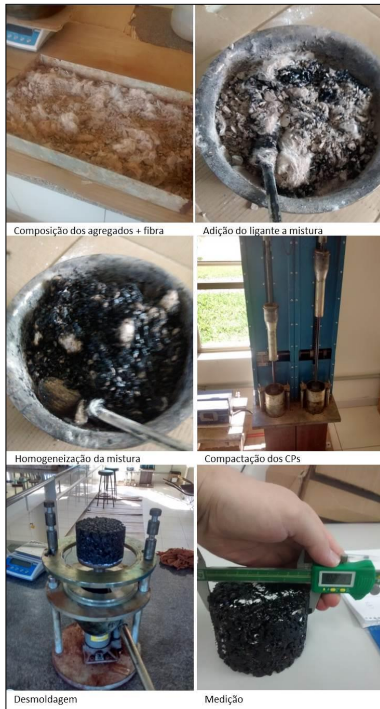
Figura 21 – Moldagem dos corpos de prova
