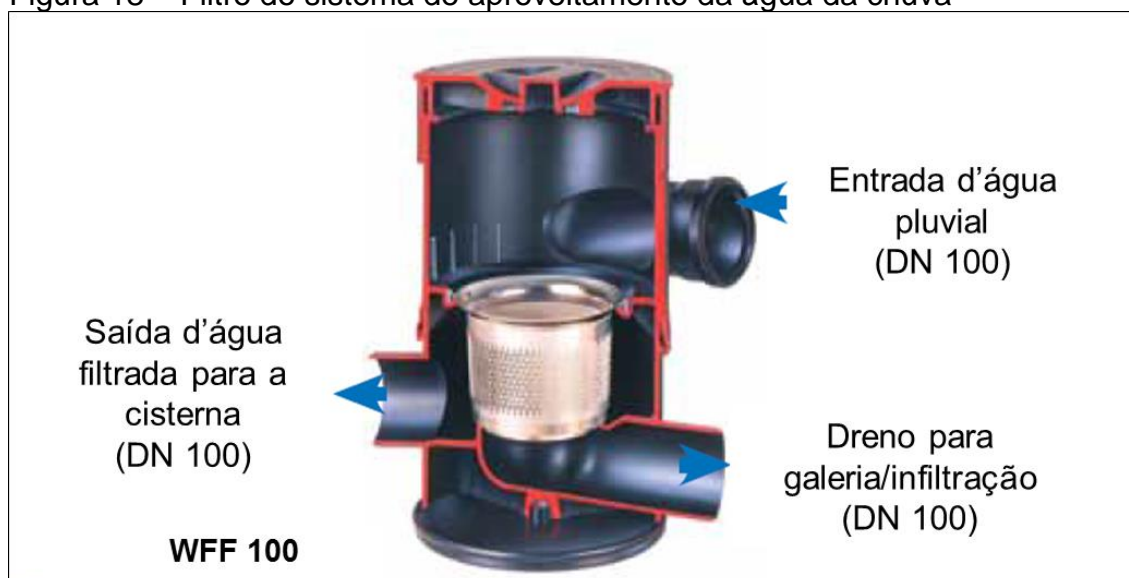
Figura 18 – Filtro do sistema de aproveitamento da água da chuva
