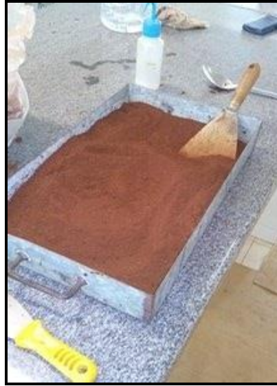
Figura 24 – Solo Destorroado e homogeneizado
