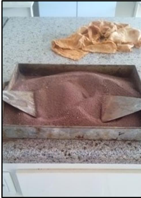
Figura 50 – Solo e cimento homogeneizados
