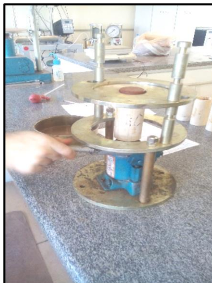
Figura 49 – Desmoldagem dos CPs
