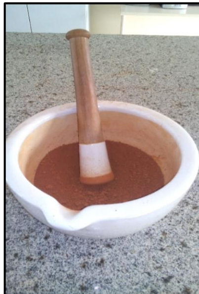
Figura 23 – Destorroamento do Solo com Almofariz
