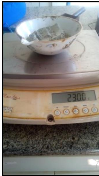
Figura 31 – Amostra de cimento para a moldagem dos Corpos de Prova
