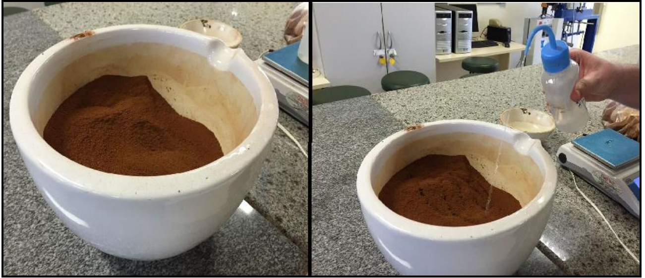
Figura 43 – Amostra do ensaio / Adição de água destilada
