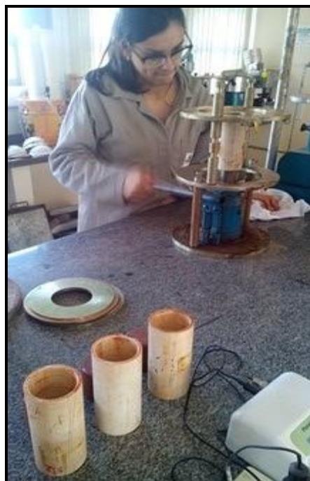
Figura 36 – Desmoldagem dos CPs após ensaio MCT
