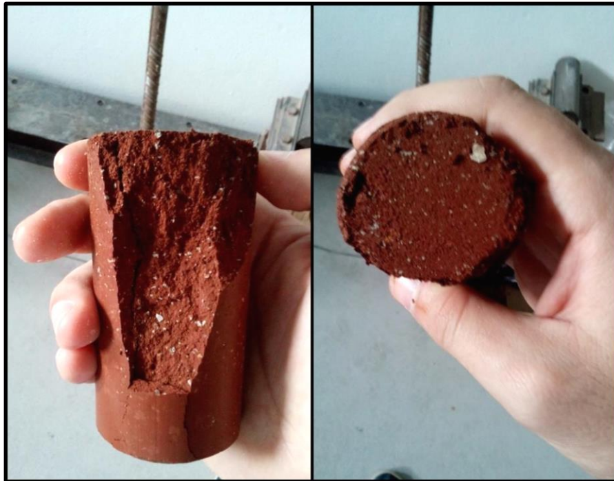
Figura 51 – Má hidratação do cimento nas amostras
