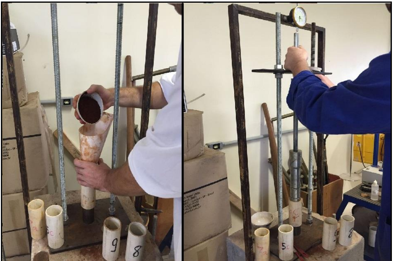
Figura 44 – Ensaio de compactação
