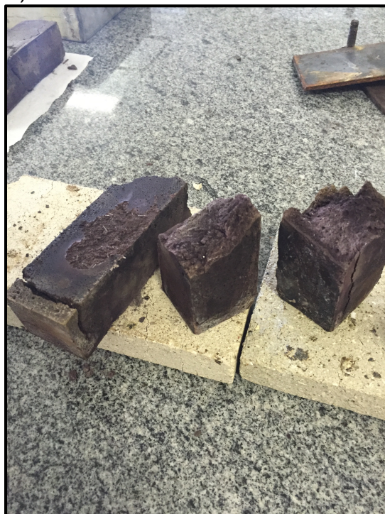
Fotografia 13 – Fissuras provocadas nas amostras devido ao fluxo de vapor: a) fissuras longitudinais; b) fissura transversal
