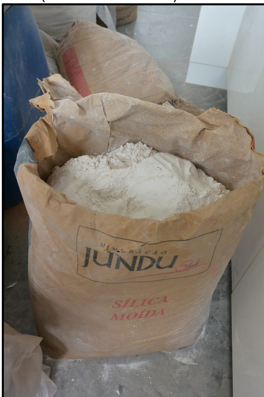
Fotografia 3 – Pó de quartzo (Sílica Moída #325)
