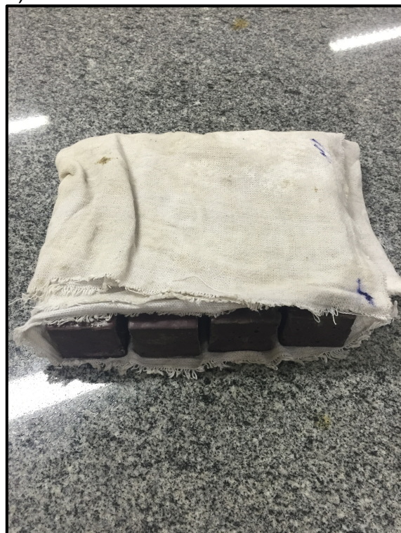
Fotografia 11 – Pré cura térmica: a) corpos-de-prova com proteção úmida na superfície, b) corpos-de-prova envoltos em pano úmido
