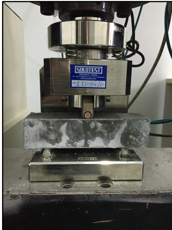
Fotografia 25 – Dispositivo de carga para ensaio de flexão a 3 pontos
