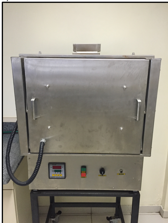
Fotografia 21 – a) Forno Mufla; b) Arranjo dos corpos-de-prova no interior do Forno Mufla
