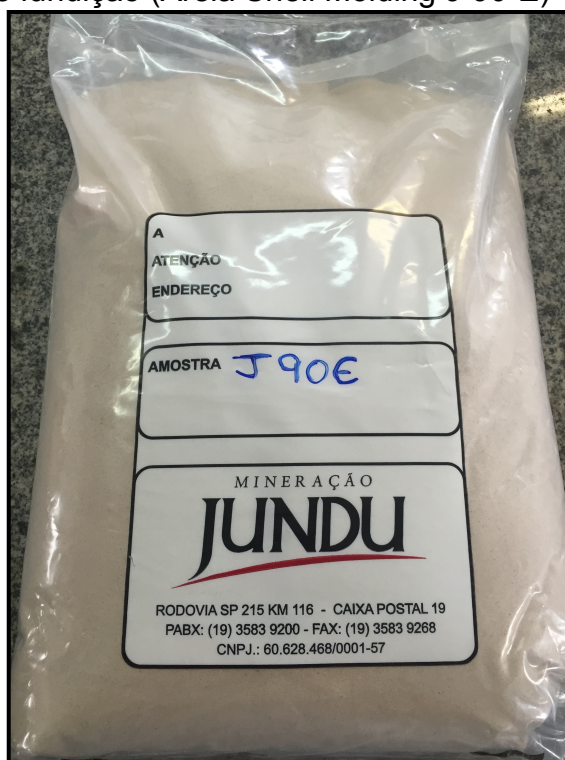
Fotografia 2 – Areia de fundição (Areia Shell Molding J-90-E)
