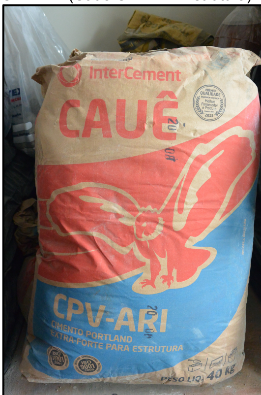
Fotografia 4 – Cimento CPV ARI (Cauê CPV ARI Estrutura)
