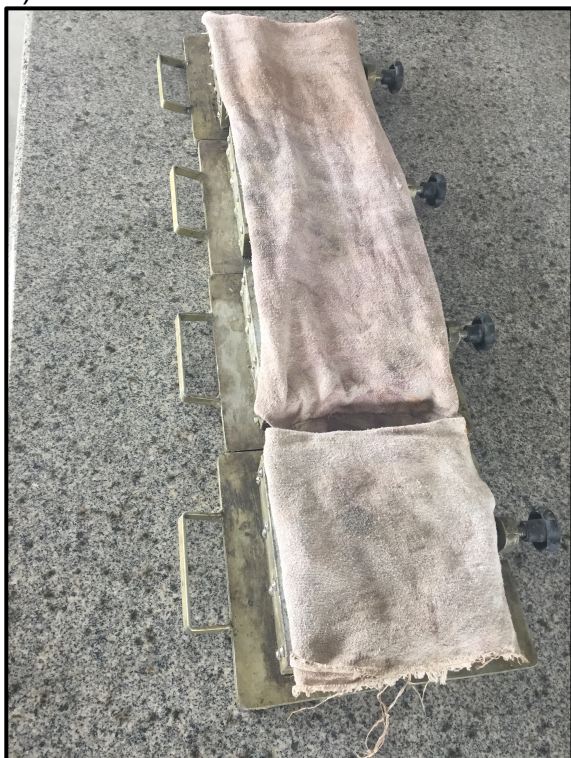
Fotografia 11 – Pré cura térmica: a) corpos-de-prova com proteção úmida na superfície, b) corpos-de-prova envoltos em pano úmido
