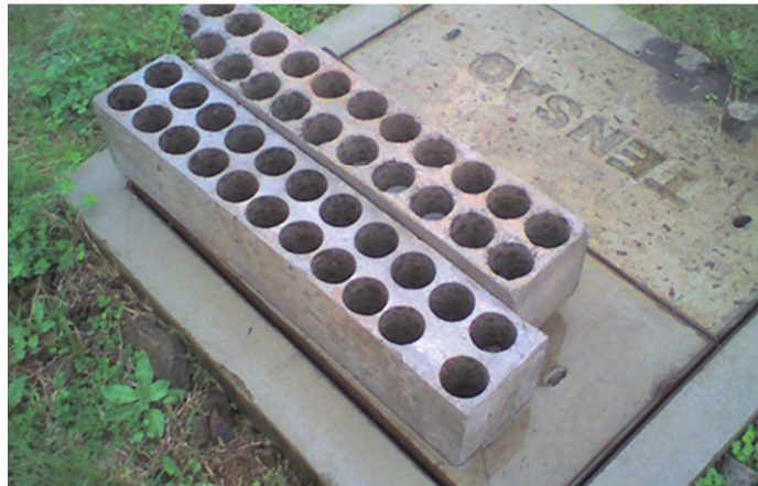
Figura 11 - vigas das quais já foram extraídos as amostras
