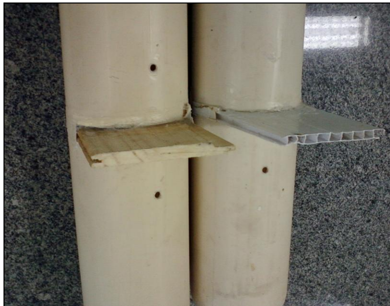
Figura 17 Tubos com os substratos de madeira e de PVC encaixados e selados a silicone
