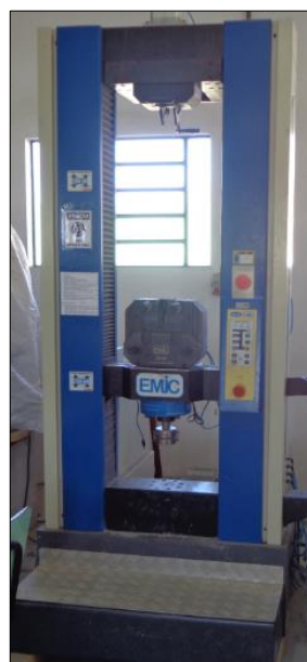
d) Máquina ensaios mecânicos EMIC DL2000
