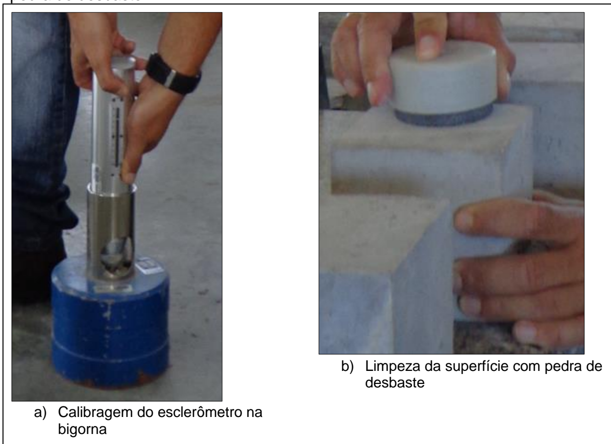
Figura 14 – Calibragem do esclerômetro na bigorna e limpeza da superfície com a pedra de desbaste
