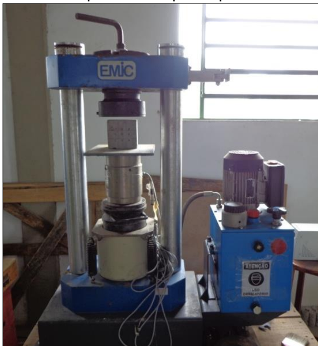
Figura 11 – Máquina utilizada na ruptura do corpo-de-prova
