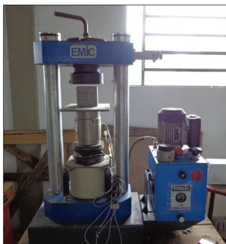
c) Máquina ensaios mecânicos EMIC PC150
