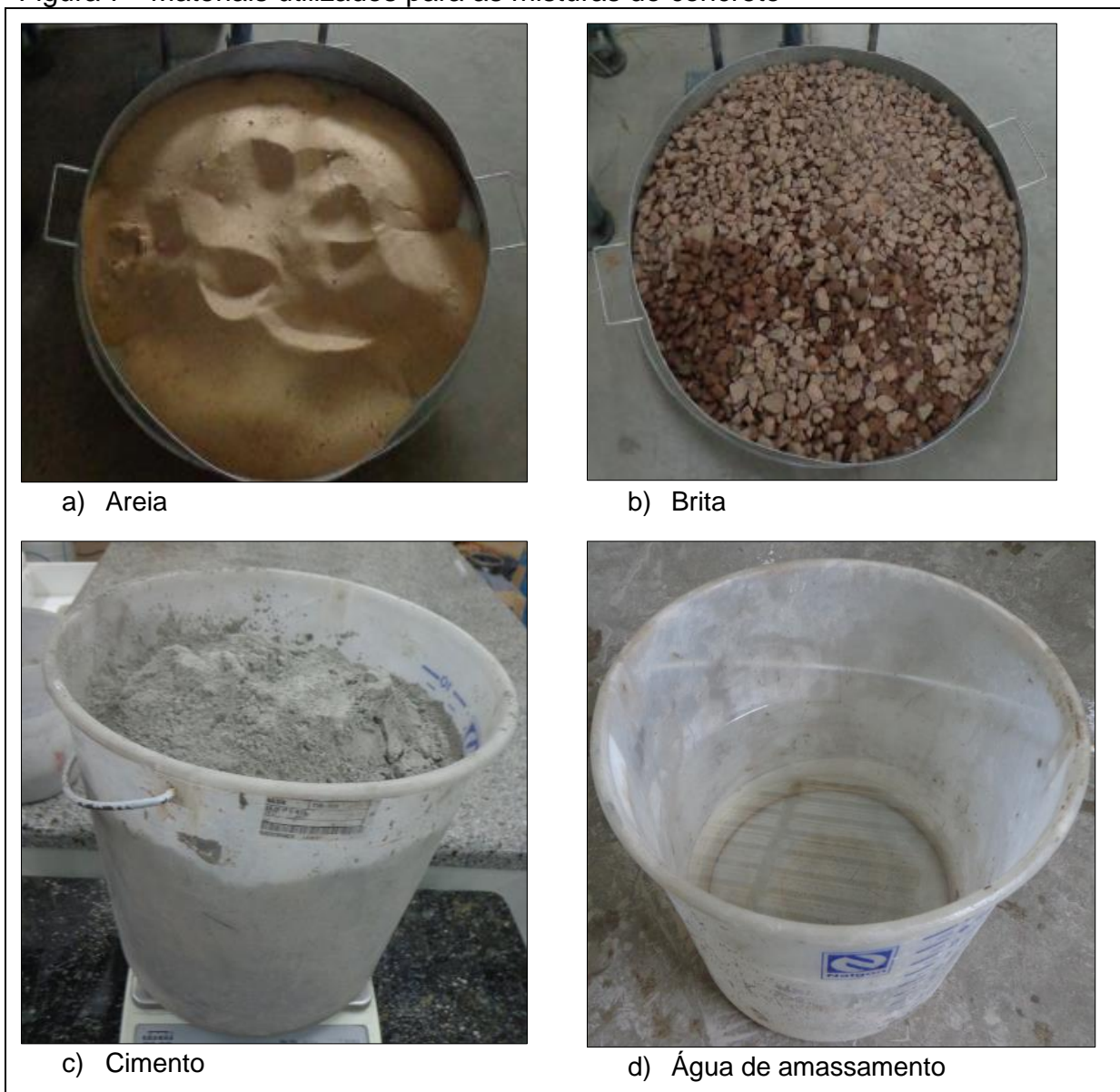
Figura 7 - Materiais utilizados para as misturas do concreto
