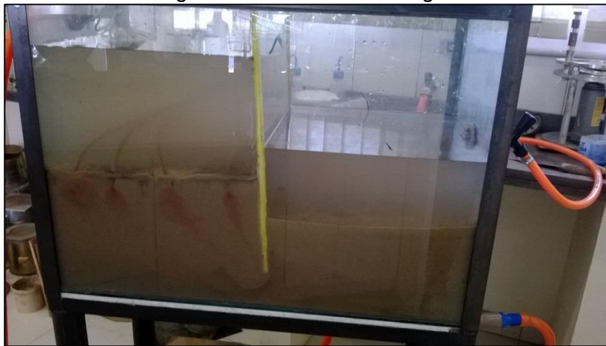
Figura 25 – Detalhe das mangueiras e do início do surgimento das linhas de fluxo
