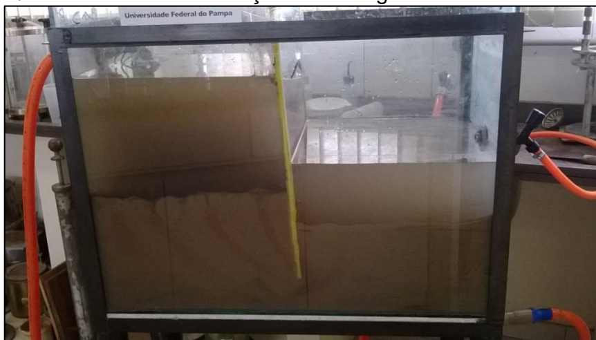
Figura 27 – Quatro linhas de fluxo traçadas ao longo do solo
