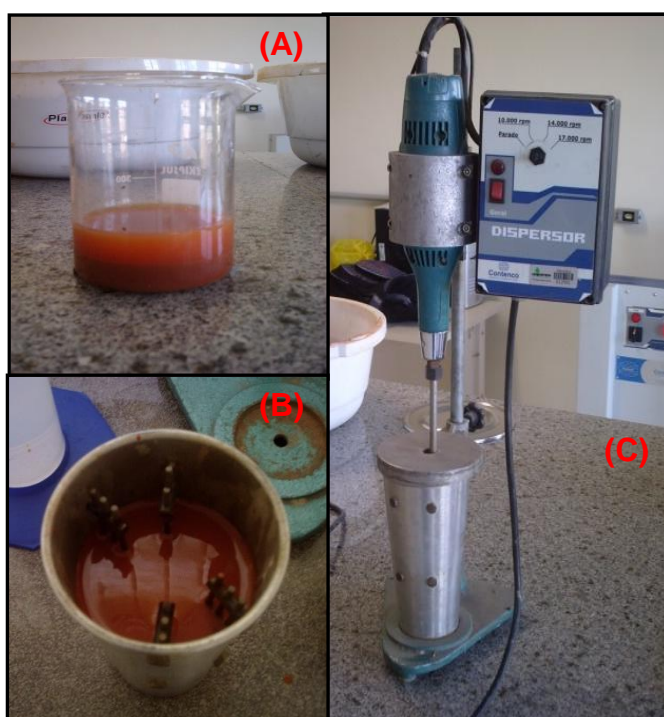
Figura 16 - Material no desfloculante (A), copo dispersor (B) e aparelho de dispersão (C)
