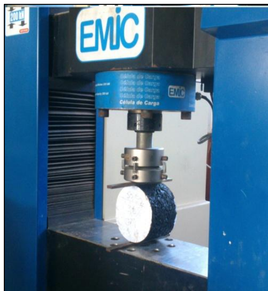
Figura 47 - Ensaio de ruptura à tração por compressão diametral
