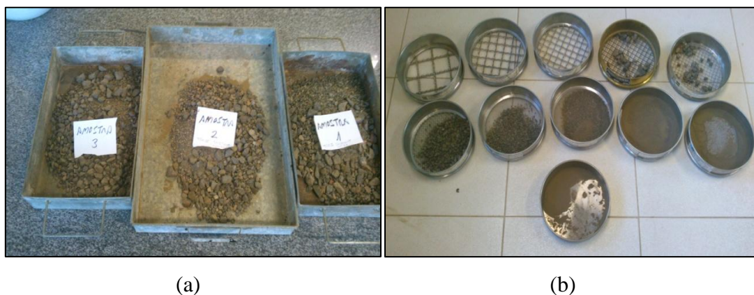
Figura 34 - Peneiramento de amostras após extração do ligante
