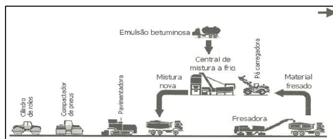
Figura 11 - Fases de intervenção na reciclagem a frio, em central, com emulsão
