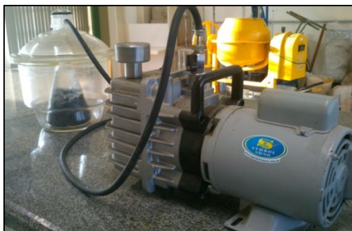
Figura 25 - Aplicação de vácuo com auxílio de bomba
