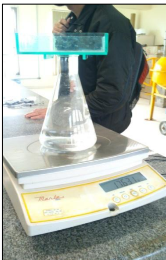
Figura 24 - Determinação do peso do kitasato com água
