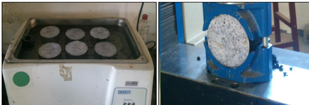
Figura 46 - Corpos-de-prova em banho e molde do ensaio Marshall
