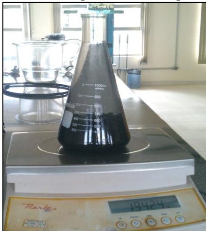
Figura 26 - Kitasato com amostra com água e amostra após aplicação de vácuo
