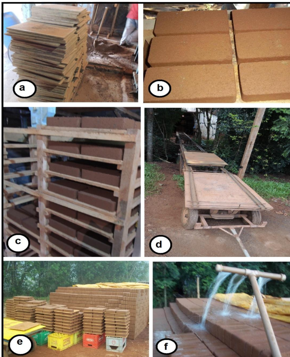
Figura 28 – Processo de secagem dos tijolos de solo-cimento
