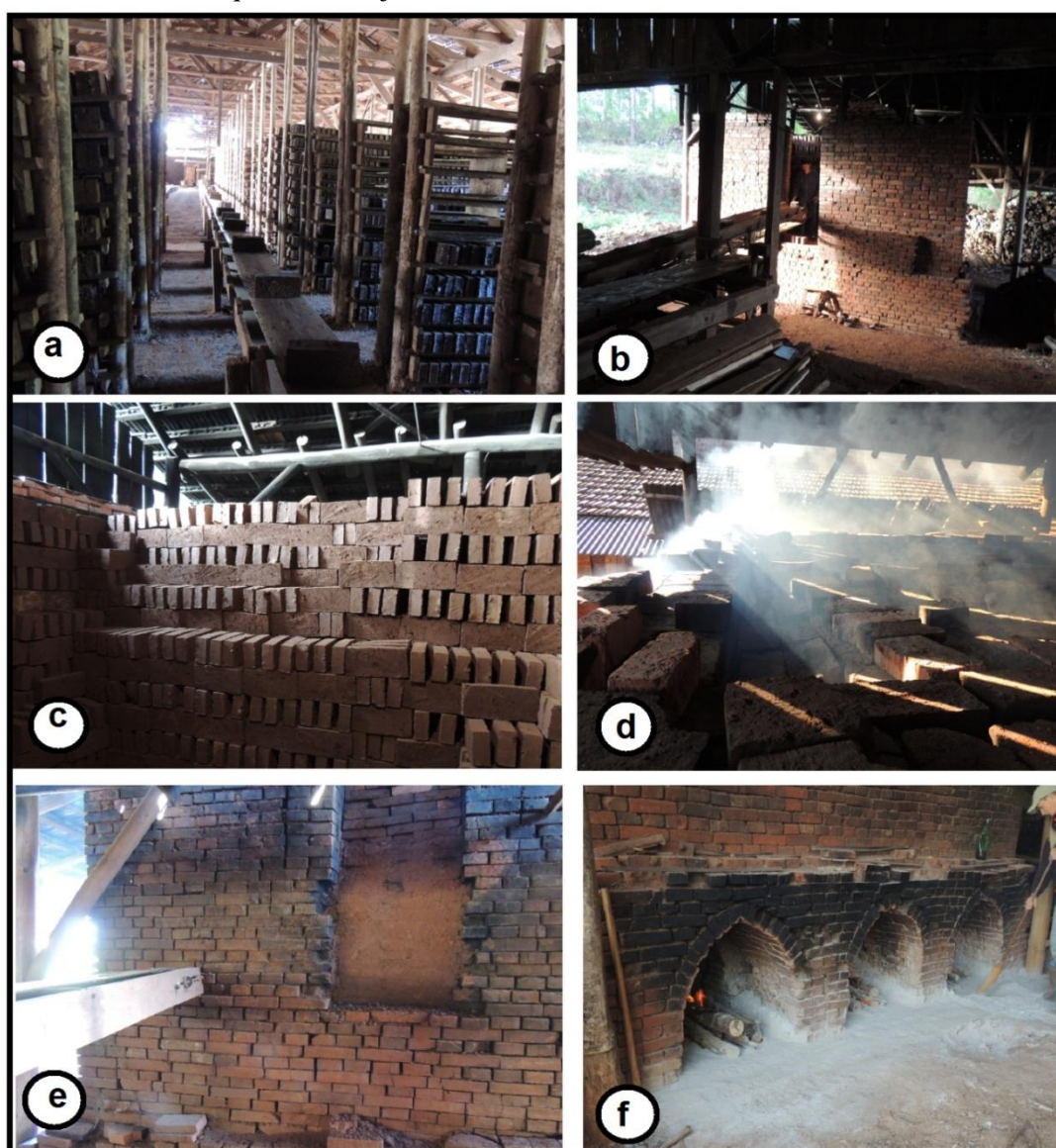
Figura 27 – Processo de queima dos tijolos cerâmicos
