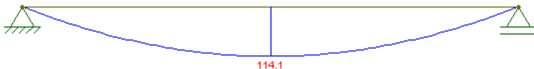
Figura 5.13 – Análise linear, diagrama de momento fletor, viga V4 (KN.m).
