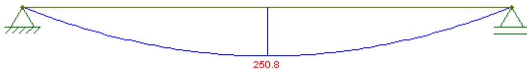
Figura 5.10 – Análise linear, diagrama de momento fletor, viga V3 (KN.m).
