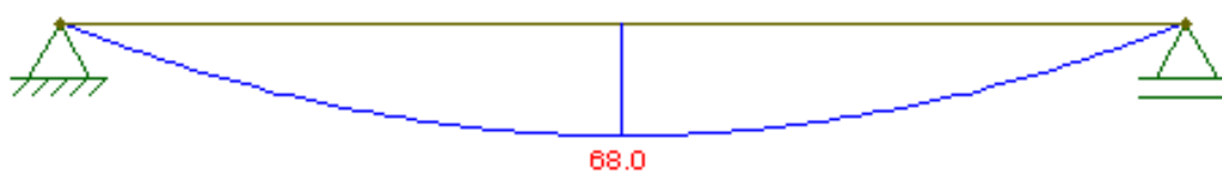
Figura 6.8 – Diagrama de momento fletor, viga/laje (KN.m).
