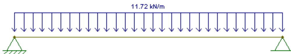
Figura 5.2 – Cargas atuantes na viga V1.
