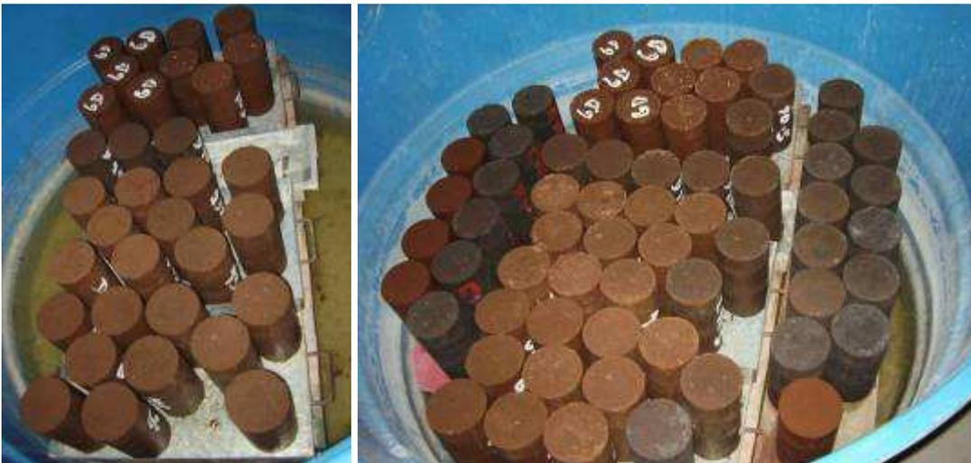
FIGURA 31 - Cura úmida dos CPs dentro de um reservatório
