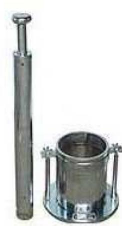
FIGURA 8 - Soquete e cilindro para ensaio de compactação Proctor
