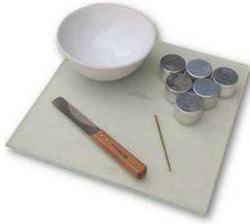
FIGURA 4 - Ensaio de limite de plasticidade
