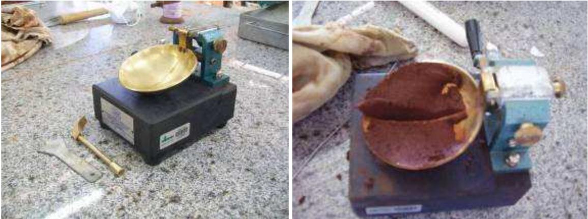
FIGURA 24 - Aparelho de Casagrande
