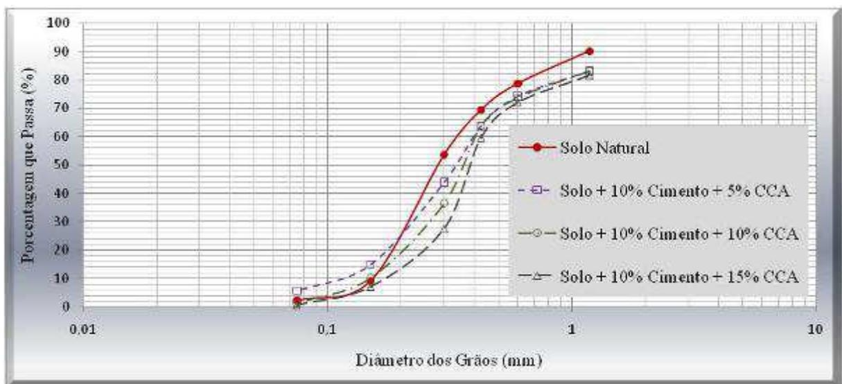
FIGURA 40 - Curva Granulométrica do Solo e misturas solo-cimento-CCA
