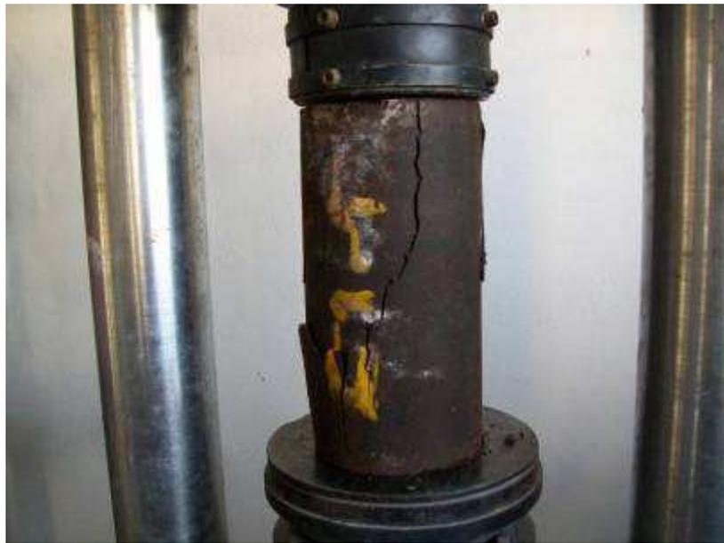
FIGURA 38 - Modo de ruptura dos corpos-de-prova submetidos a RCS
