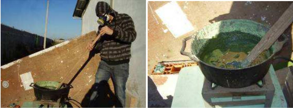
FIGURA 32 - Derretimento do enxofre e caulim
