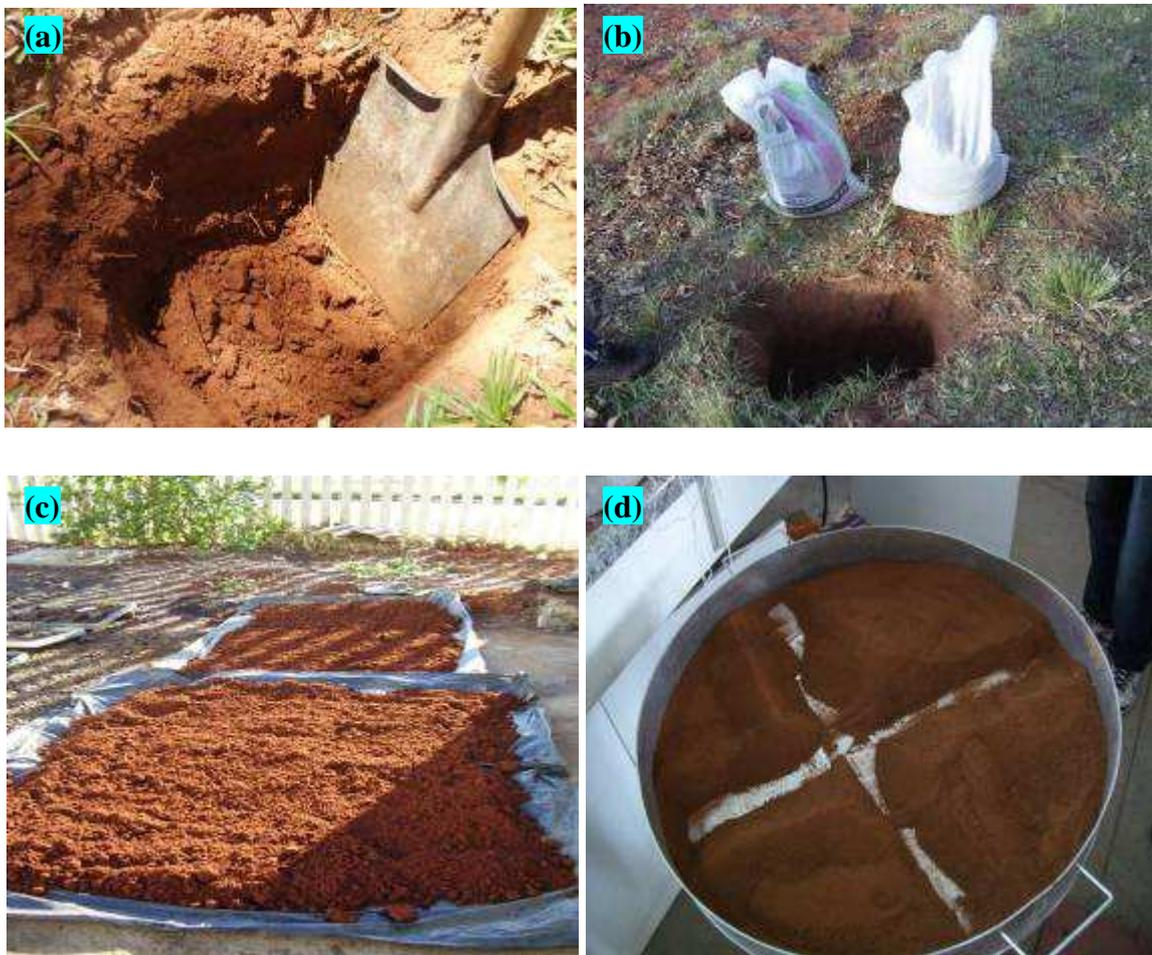
FIGURA 18 - (a) Coleta do solo, (b) Solo acondicionado em sacos, (c) Solo para secagem, (d) solo quartado.
