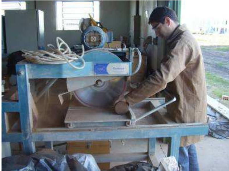
FIGURA 34 - Serragem dos topos dos corpos-de-prova
