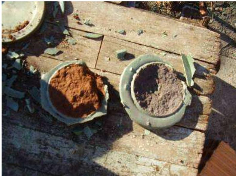
FIGURA 33 - Topos dos CP's aderidos ao capeamento
