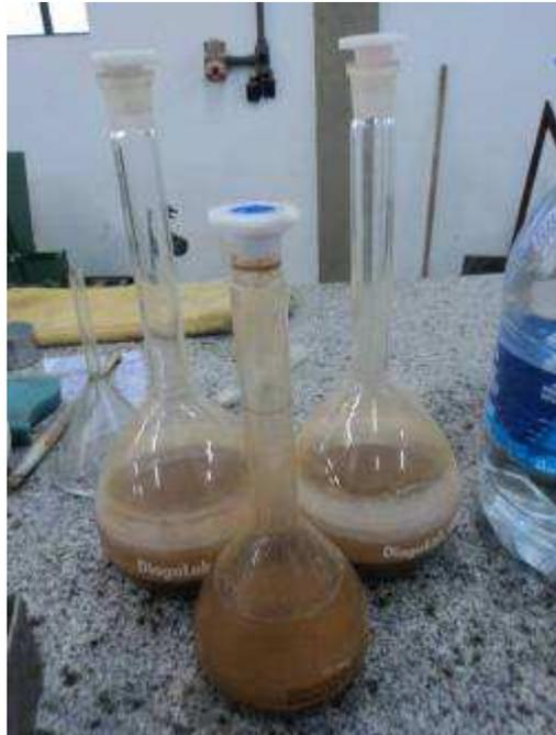
FIGURA 23 - Picnômetros com amostras
