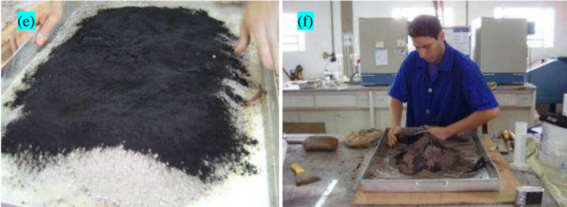
FIGURA 21 - Preparação das misturas solo-cimento-cinza.
