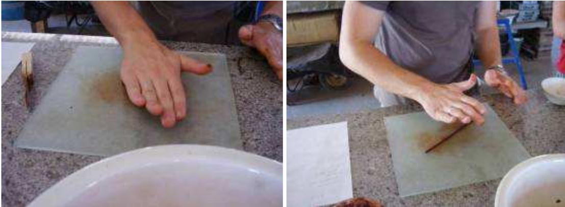
FIGURA 26 - Ensaio de limite de plasticidade
