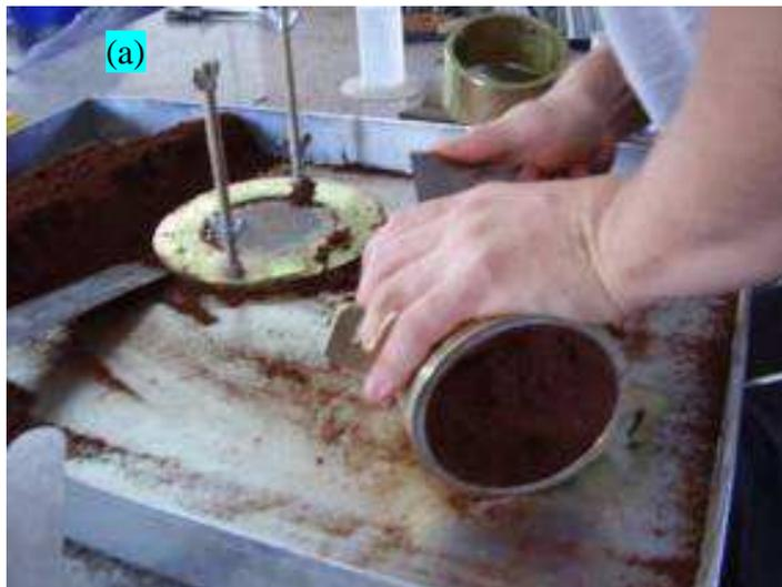
FIGURA 28 - Realização do Ensaio de Proctor
