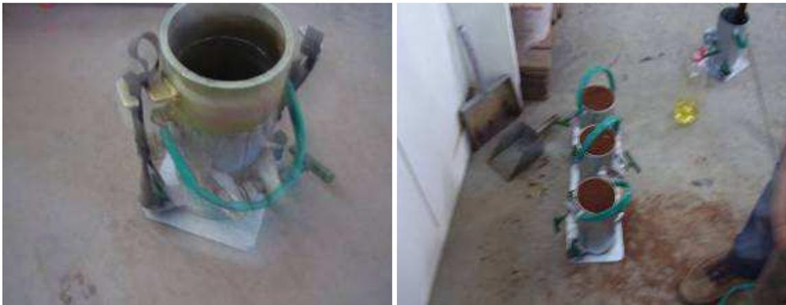
FIGURA 29 - Moldagem dos corpos-de-prova
