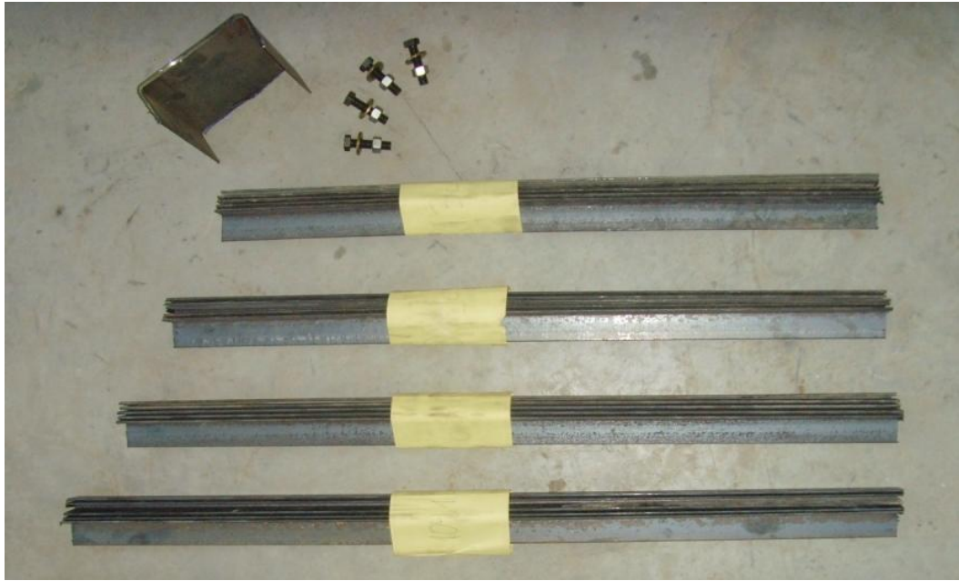
Figura 11 – Corpos de prova cortados e base para fixação das ligações parafusadas. Fonte: O autor.
