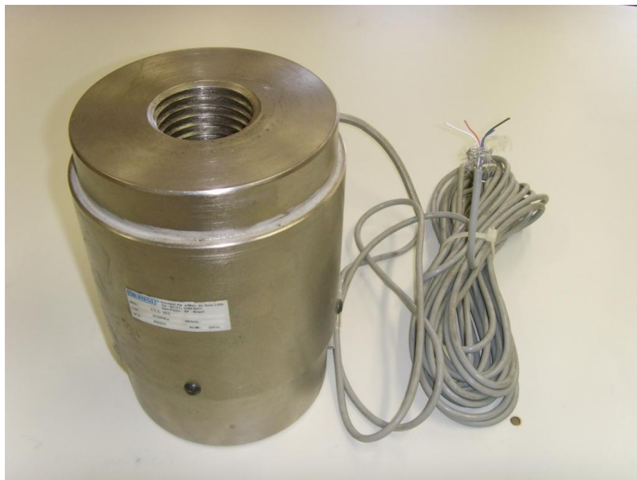
Figura 10 – Célula de carga Kratos CCI-30T . Fonte: O autor.
