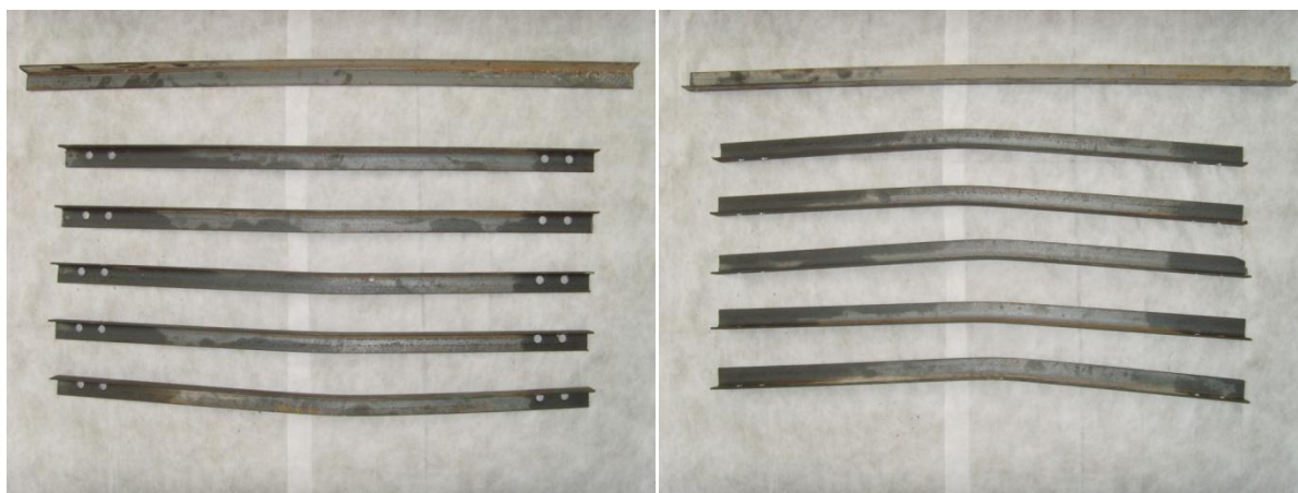
Figura 22 – (a) Esbeltez 110, lado A; (b) Esbeltez 110, lado B. Fonte: O autor.
