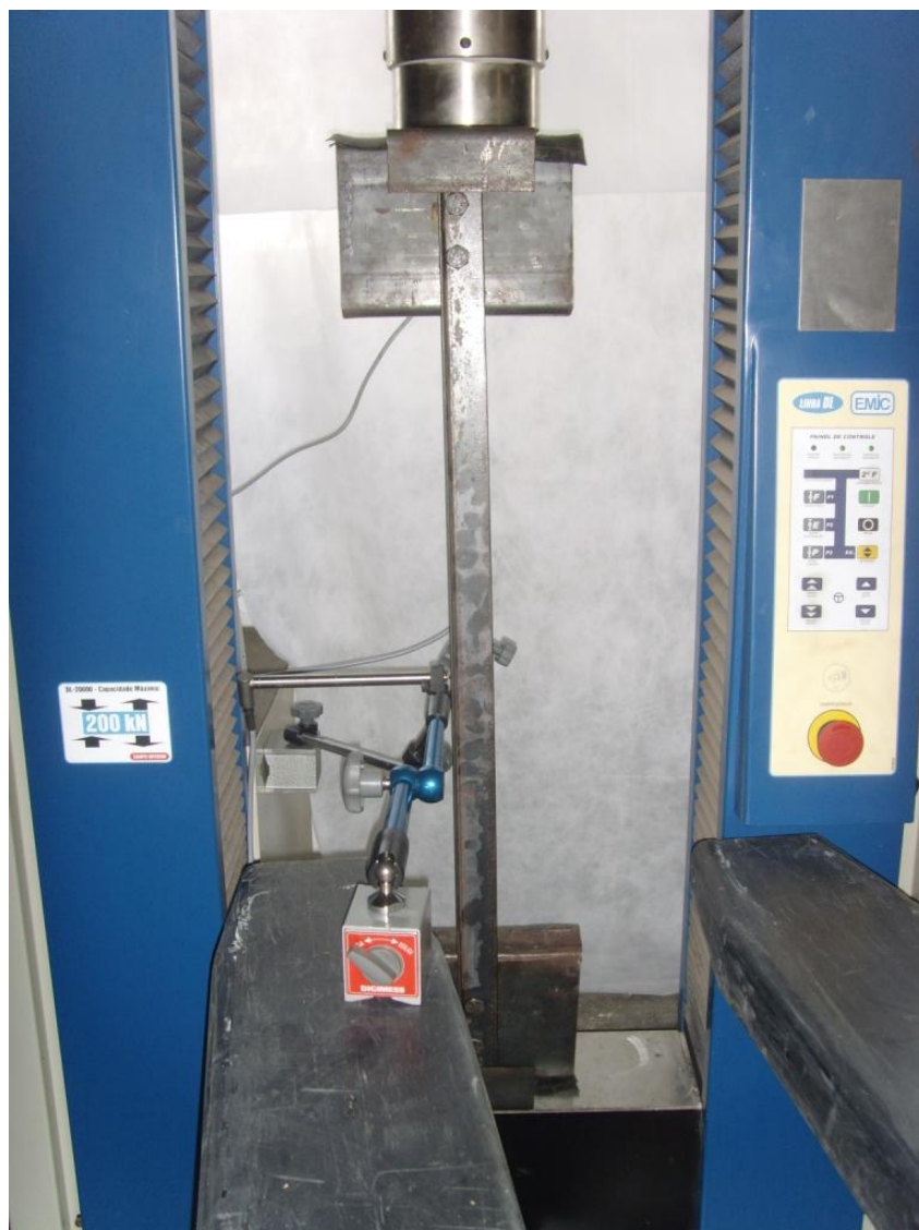
Figura 17 – Ensaio de compressão nas cantoneiras conectadas por uma aba. Fonte: O autor.
