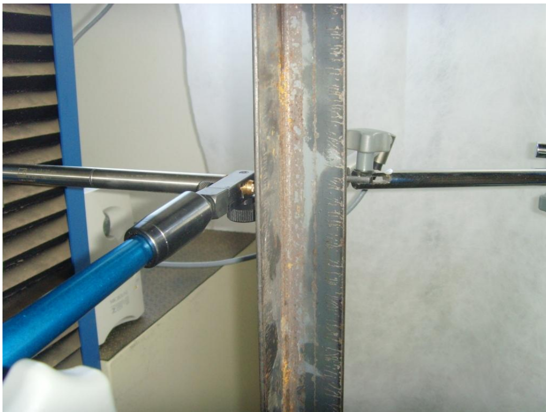
Figura 18 – Colocação das bases magnéticas e LVDT's. Fonte: O autor.
