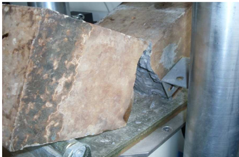
FIGURA 4.11 - Ruptura à flexão de viga sem adição de fibra de aço.
