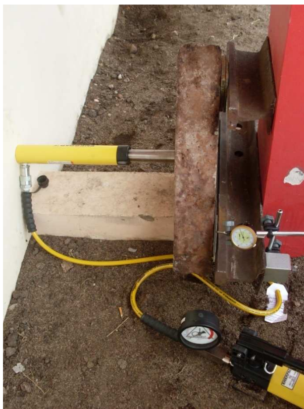
FIGURA 3.12 - Configuração do ensaio de flexão em placa triangular.
