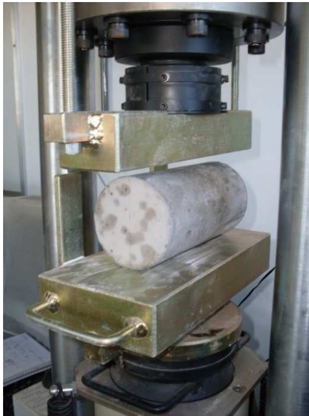
FIGURA 3.7 - Dispositivos específicos acoplados à prensa para realização do ensaio de compressão diametral.
