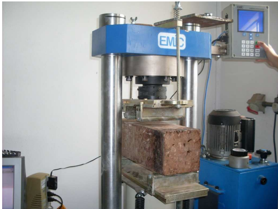
FIGURA 3.8 - Ensaio de flexão em vigas.
