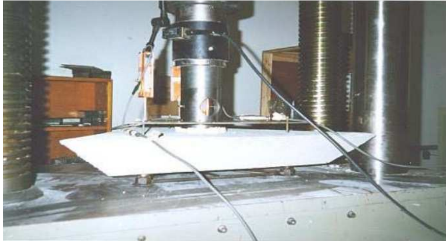
FIGURA 2.4 - Configuração do ensaio de flexão em placa triangular, utilizando polivinil expandido como apoio do dispositivo central (ALMEIDA, 1999).
