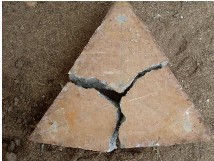
FIGURA 4.16 - Ruptura de placa triangular sem fibra de aço.
