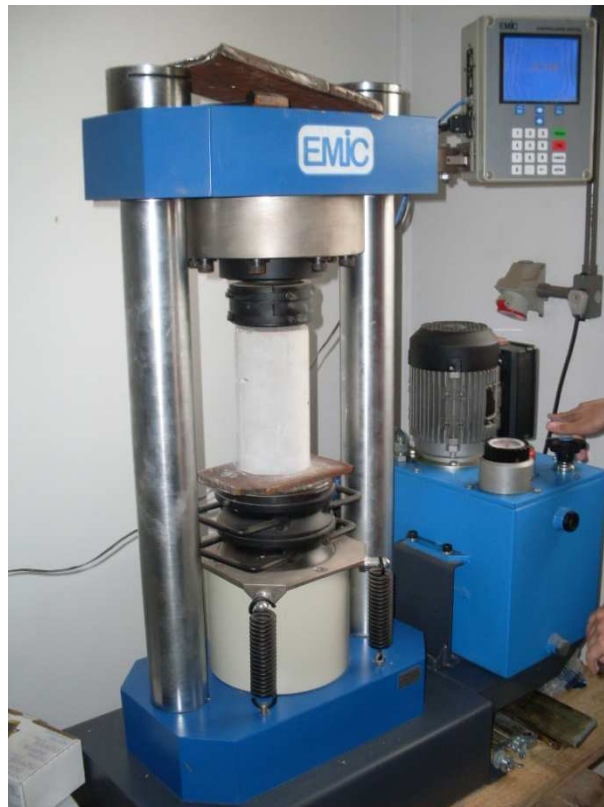
FIGURA 3.6 - Execução do ensaio de compressão axial.
