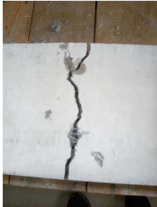
FIGURA 4.10 - Ruptura à flexão de viga com adição de fibra de aço.
