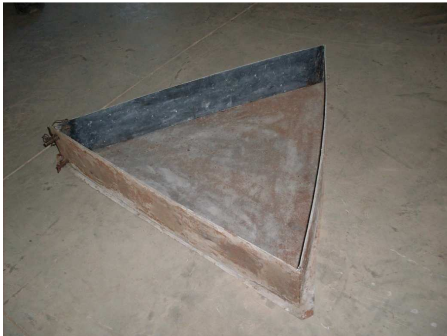
FIGURA 3.4 - Forma utilizada na confecção das placas triangulares.
