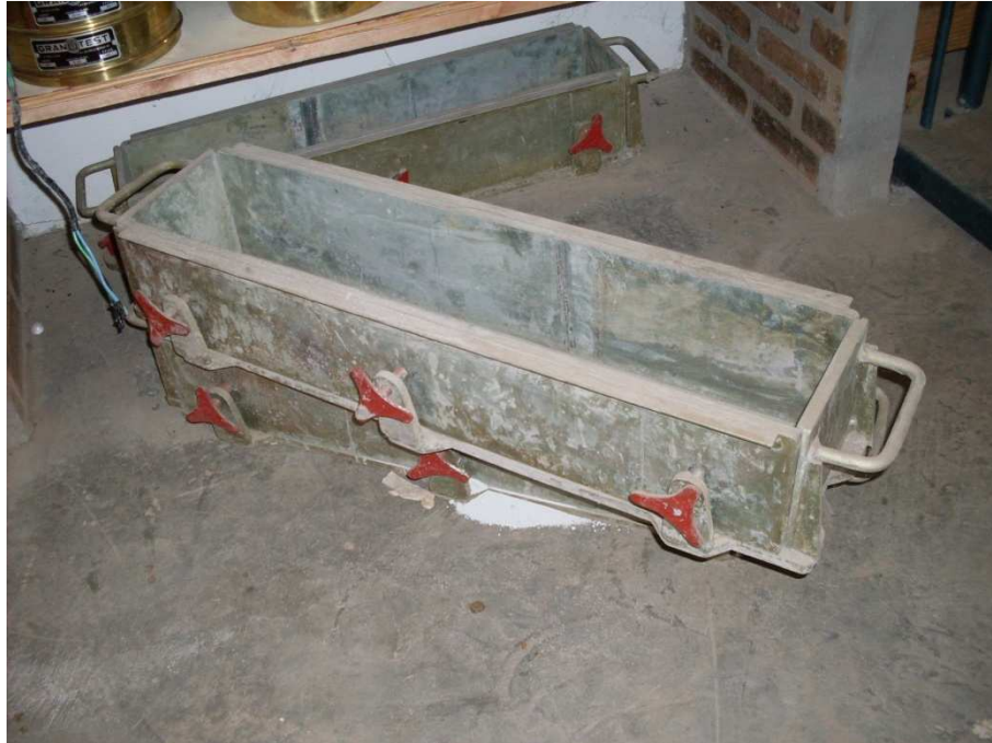
FIGURA 3.3 - Forma utilizada na confecção dos corpos-de-prova prismáticos (vigas).
