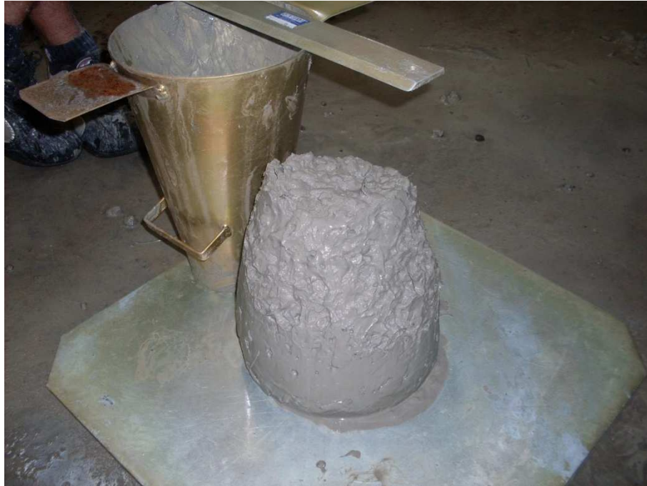
FIGURA 3.5 - Abatimento do tronco de cone.
