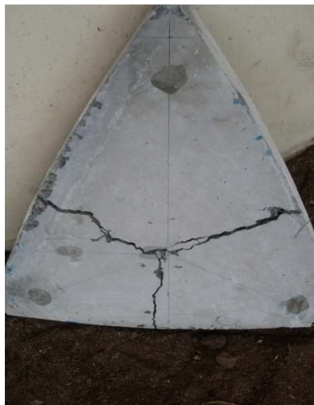
FIGURA 4.17 – Ruptura de placa triangular com fibra de aço.
