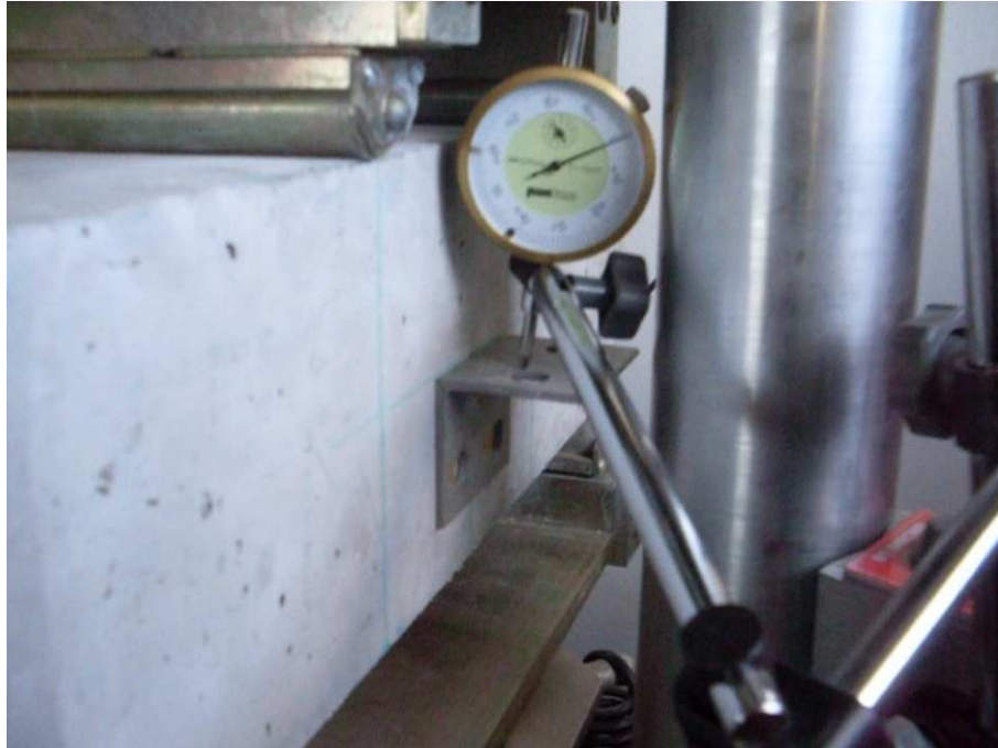
FIGURA 3.9 - Relógio comparador acoplado em uma base magnética.
