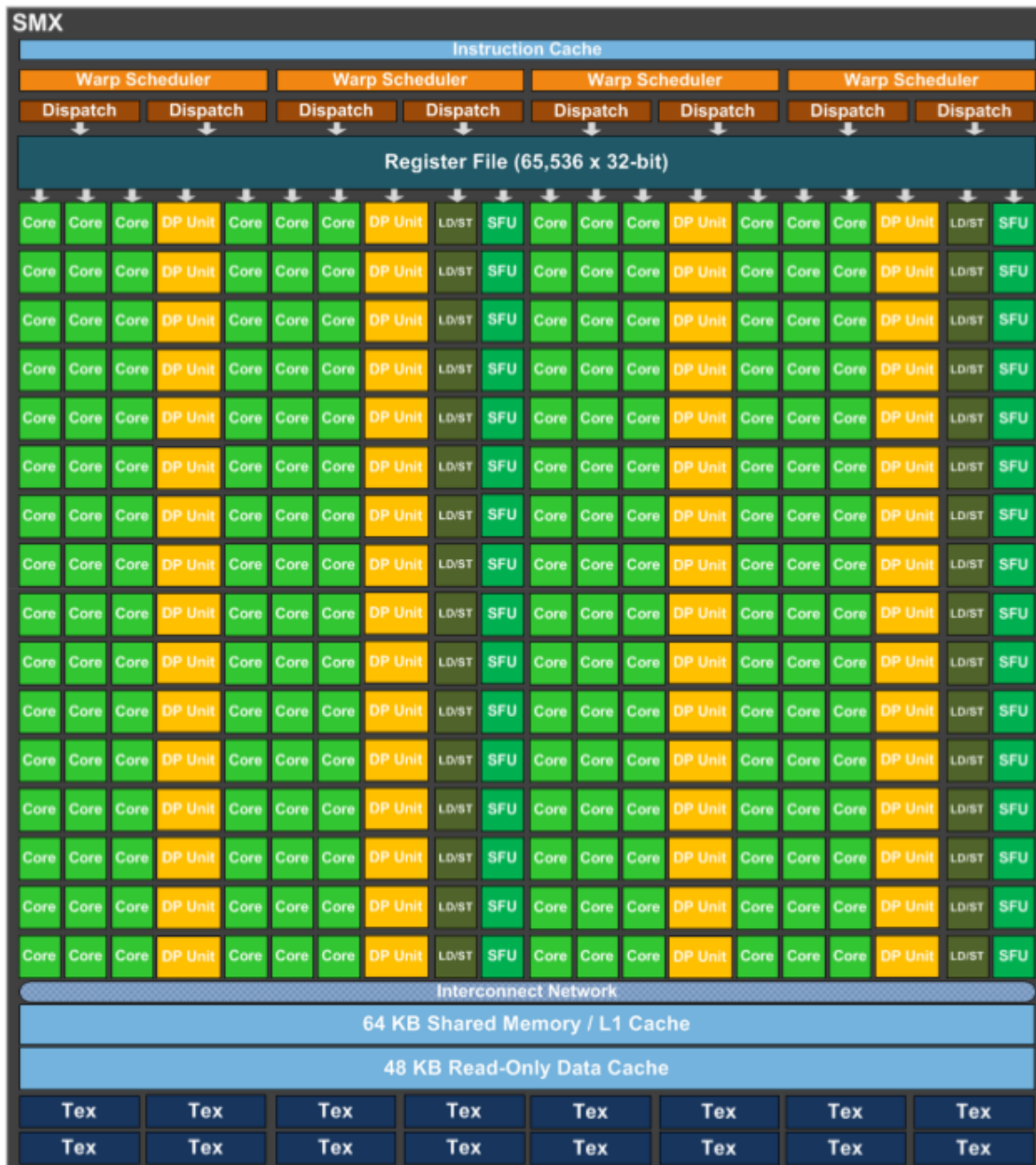
Figura 13 – Multiprocessador de streaming da arquitetura Kepler.
