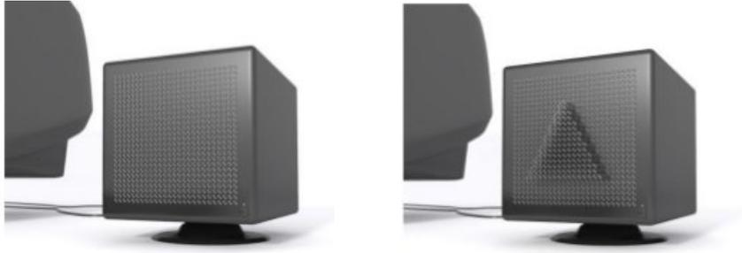
Figura 8 – Demonstração da placa de pinos projetada para percepção de formas geométricas: a) Placa antes de receber os sinais pela rede, b) Placa após receber os sinais da figura pela rede.
