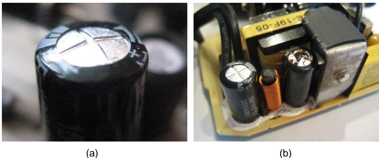
Figura 2 - Exemplos de falha de capacitores eletrolíticos. Expansão do invólucro (a) e vazamento do eletrólito (b).
