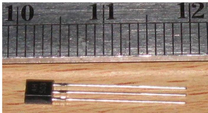
Figura 71: Sensores Hall do motor *Brushless* comercial.
