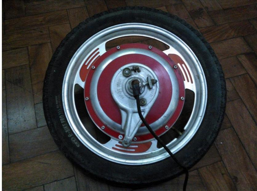
Figura 2: Motor *Brushless* ensaiado.
