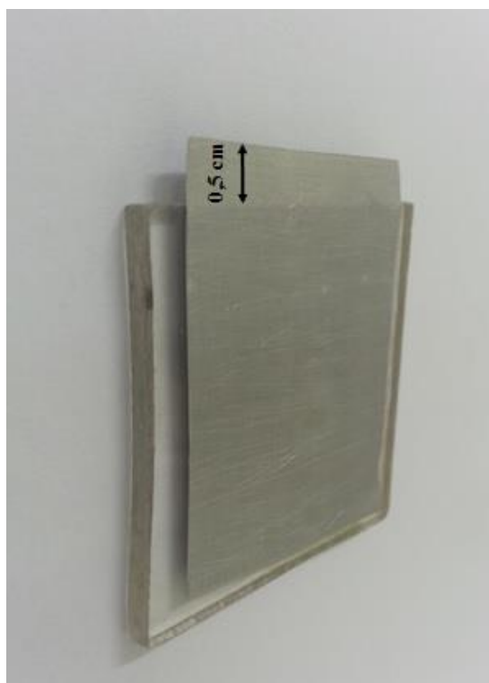
Figura 3.2 - Amostra fixada com resina acrílica (Poxipol) em placas de policarbonato.
