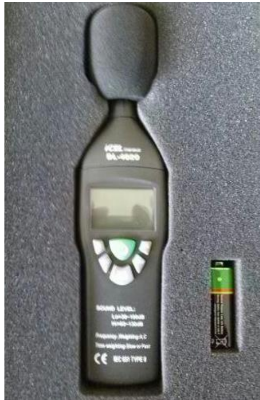
Figura 7 – Decibelímetro utilizado para obtenção de valores de ruído (dB).
