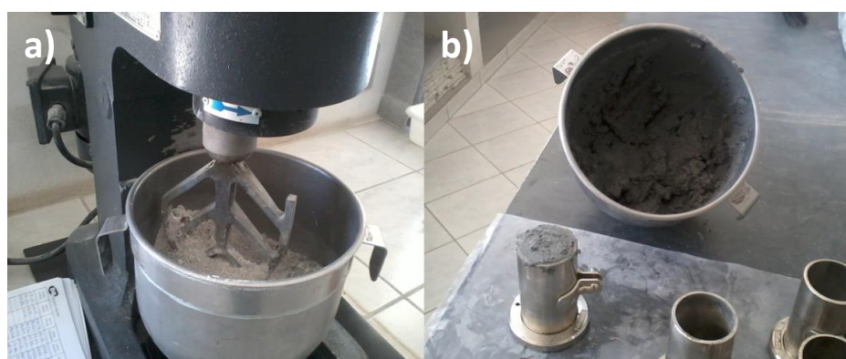
Figura 6- Argamassadeira (a) e corpos de prova sendo preenchidos com massa (b).
