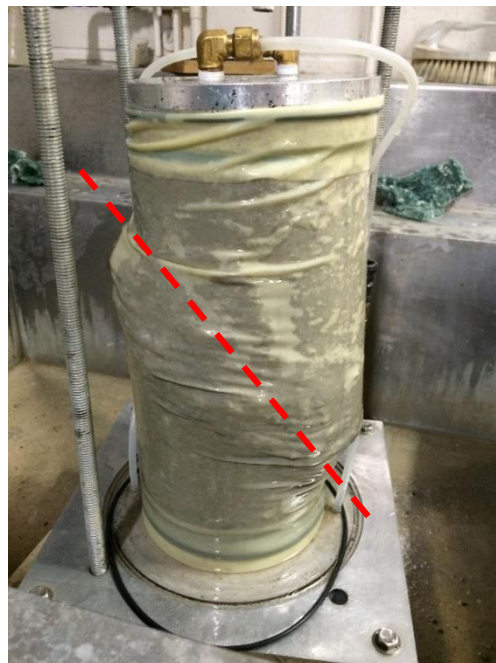
Figura 5.5 - Plano de falha para amostra de ARC.
