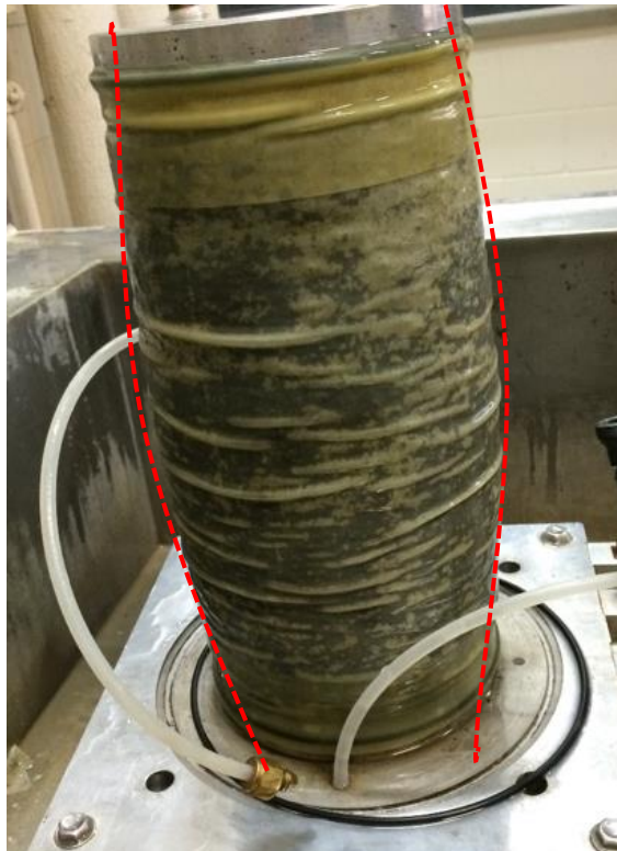
Figura 5.8 – Corpo de prova de RPA demonstrando deformação axial convexa.
