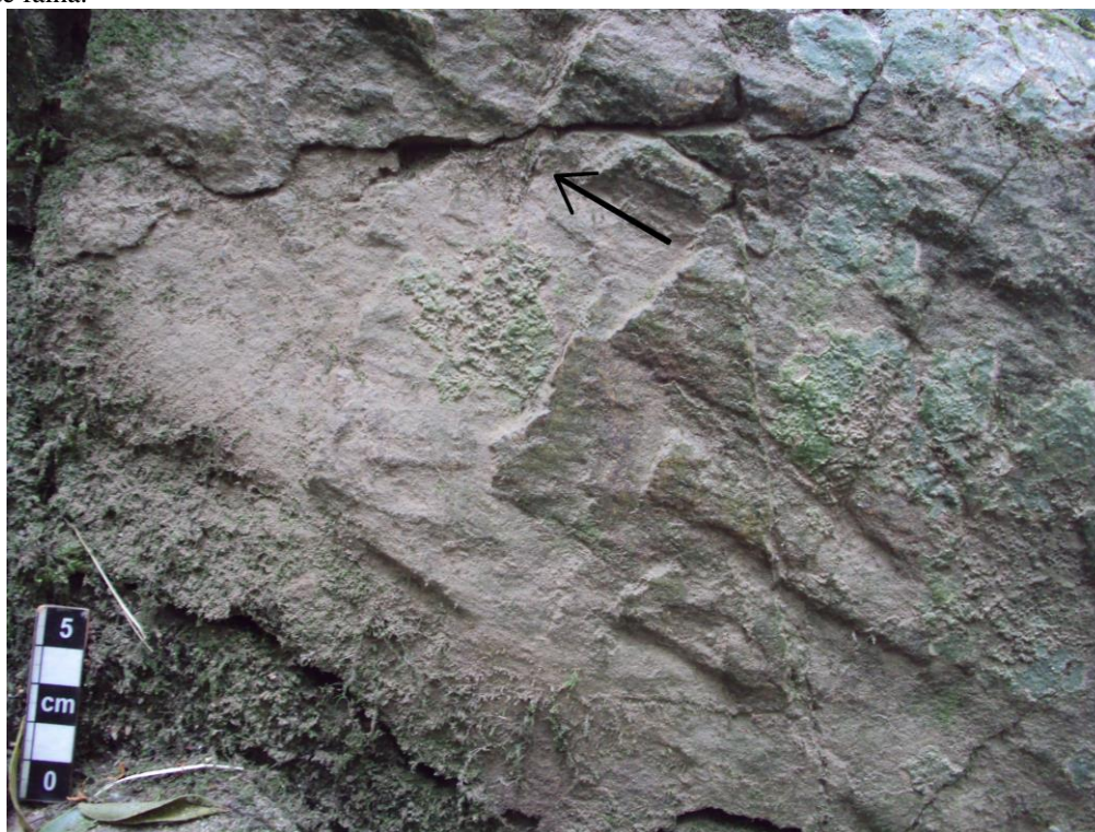
Figura 24 - Possível indicador cinemático encontrado nos granitoides do ponto 12, mostrando degraus no plano de falha.
