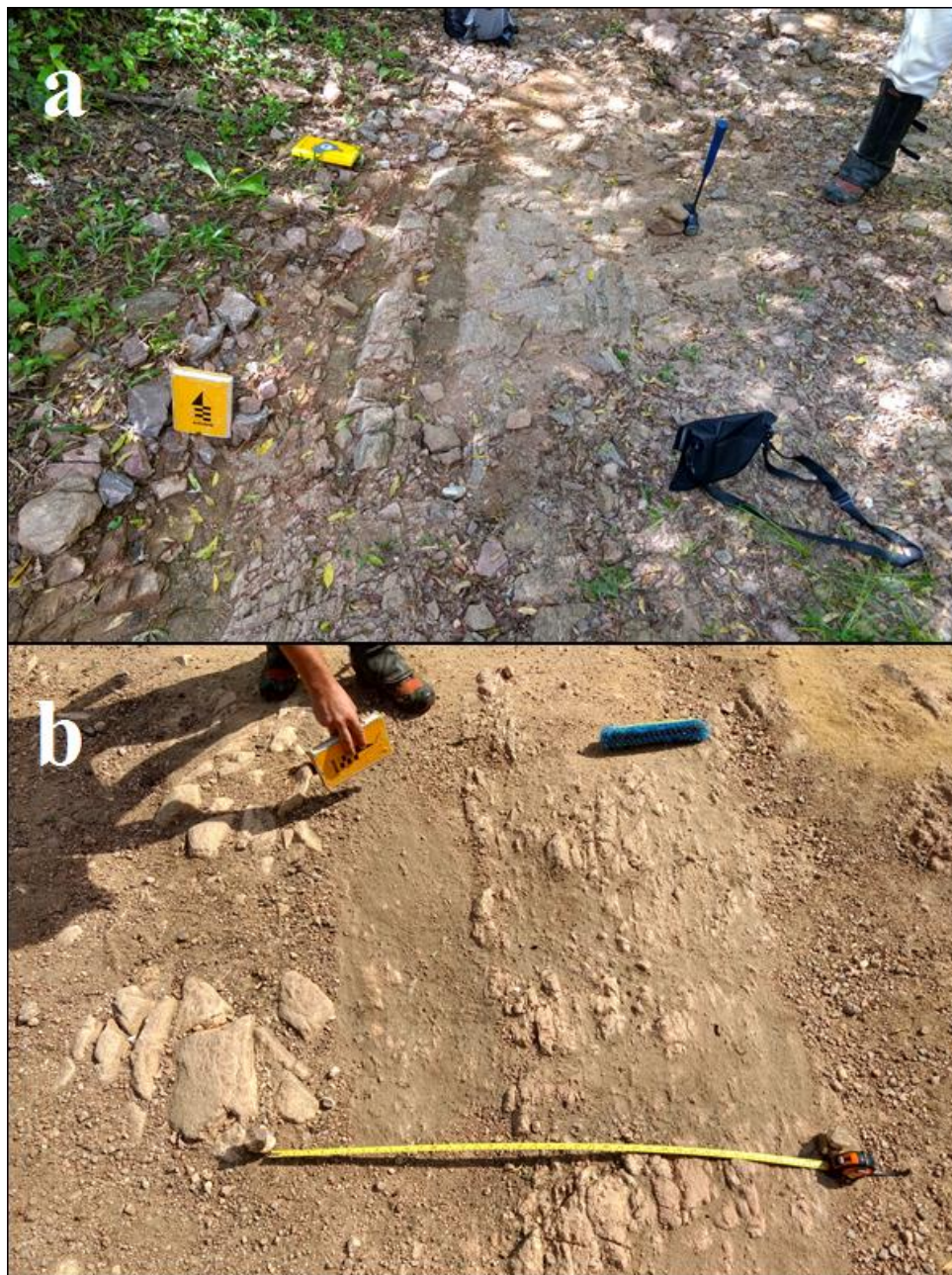
Figura 12 - Técnicas para a realização do cálculo do número de fraturas (a) por metro quadrado e (b) por perfil linear em um metro.
