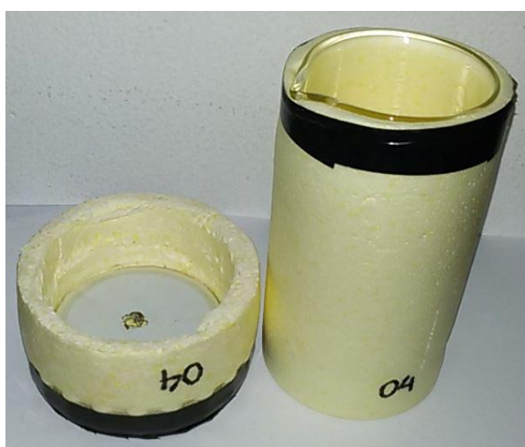
Figura 20 - Foto do calorímetro aberto
