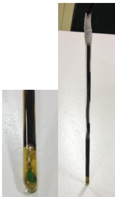
Figura 16 – Tubo de vidro contendo o termistor, meio de contato térmico e cabo de conexão elétrica. A foto da esquerda mostra o detalhe do termistor na parte inferior do tubo
