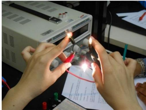
Figura 37 – Circuito com lâmpadas numa associação mista montado pelos alunos.
