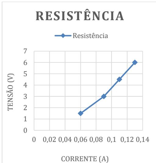
Figura 31 – Gráfico construído pelo grupo A, de um resistor não-ôhmico.
