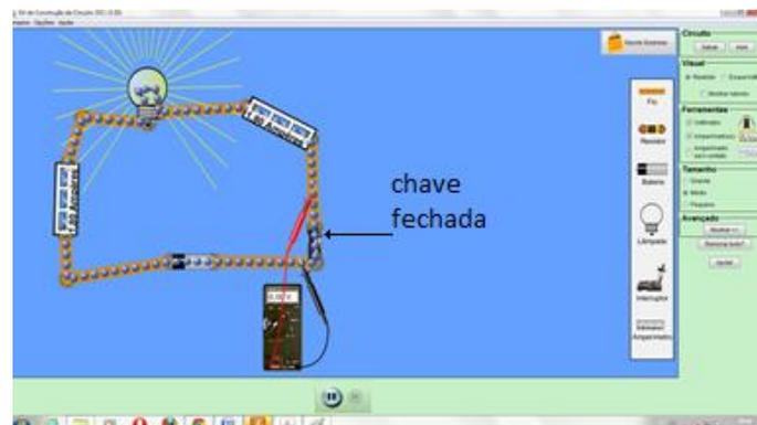
Figura 15 – Circuito simples construído pelos alunos com medição de tensão sobre o interruptor.
