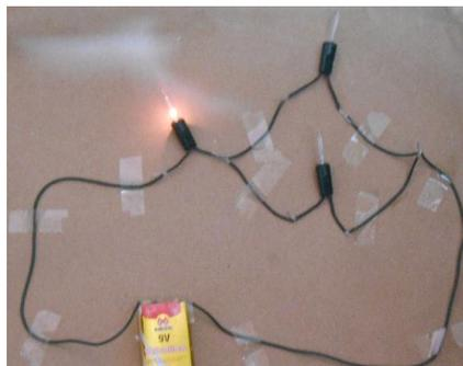
Figura 39 – Circuito elétrico misto com lâmpadas, construído pelos alunos.
