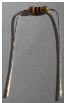
Figura 44 – Resistor de 330 $\Omega$ .
