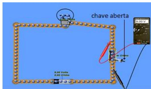
Figura 12 – Circuito simples construído pelos alunos com medição de tensão.
