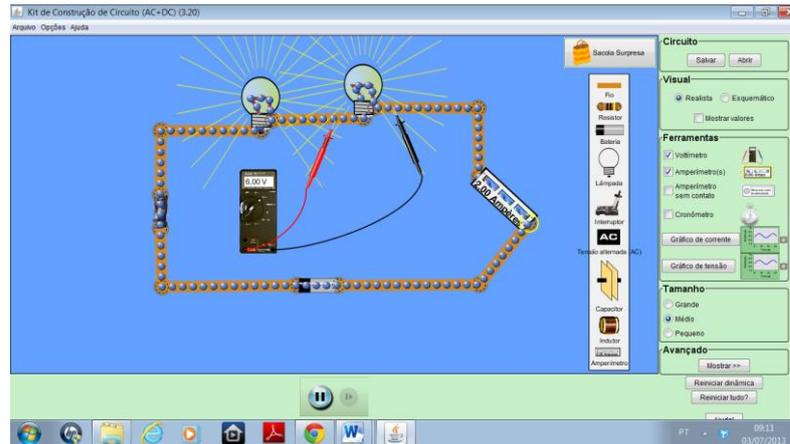
Figura 1 – Simulação de uma associação de lâmpadas em série.
